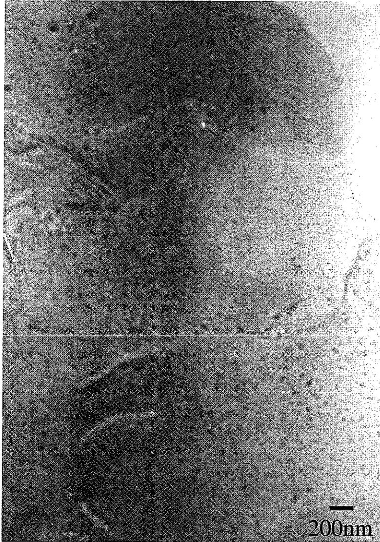
図3-67 500°C結果、 $2 \times 10^{17}$ ion/cm<sup>2</sup>照射試料(領域1)
