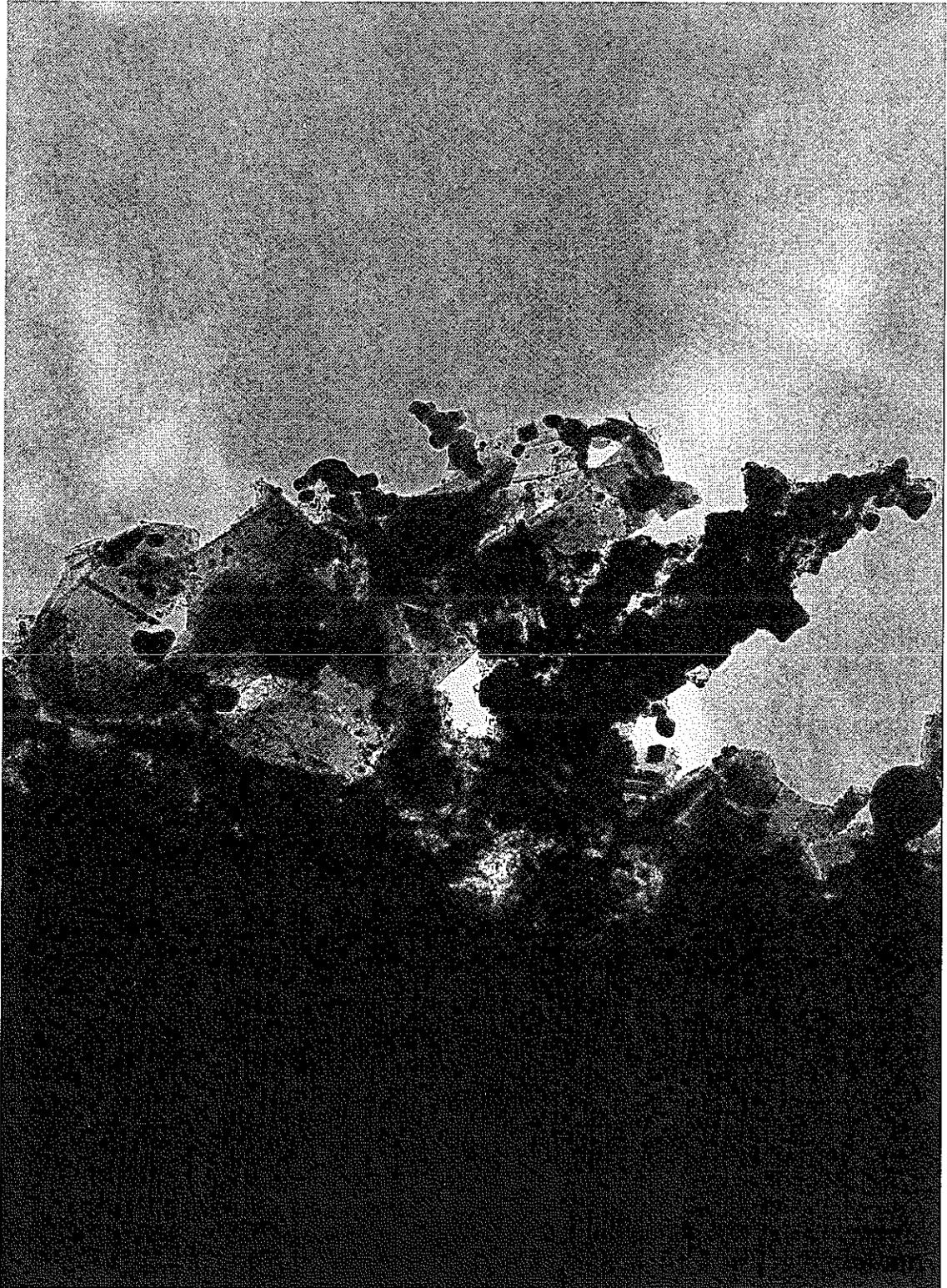
図3-108 1200°C結果、 $2 \times 10^{17}$  ion/cm<sup>2</sup>照射試料
