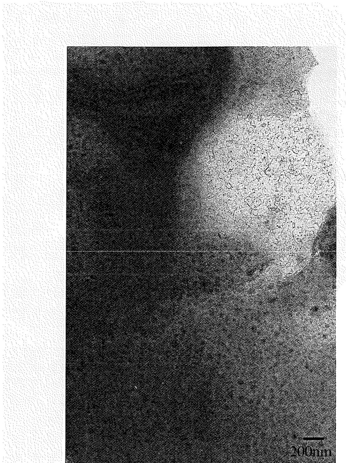
図3-58 室温結果、 $2 \times 10^{17}$ ion/cm<sup>2</sup>照射試料(領域1)
