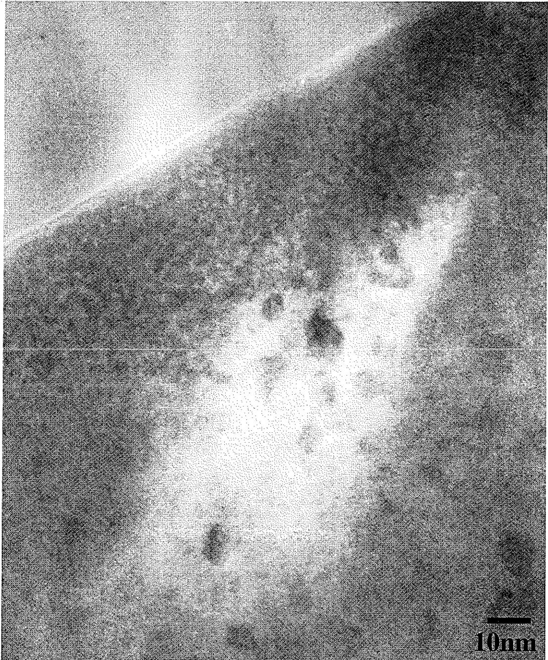
図3-30  $1 \times 10^{13} \text{ion/cm}^2$ 照射試料観察(領域1)
