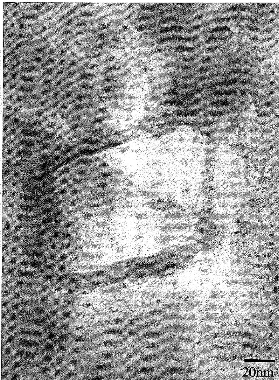
図3-102 1000°C結果、 $2 \times 10^{17}$  ion/cm<sup>2</sup>照射試料
