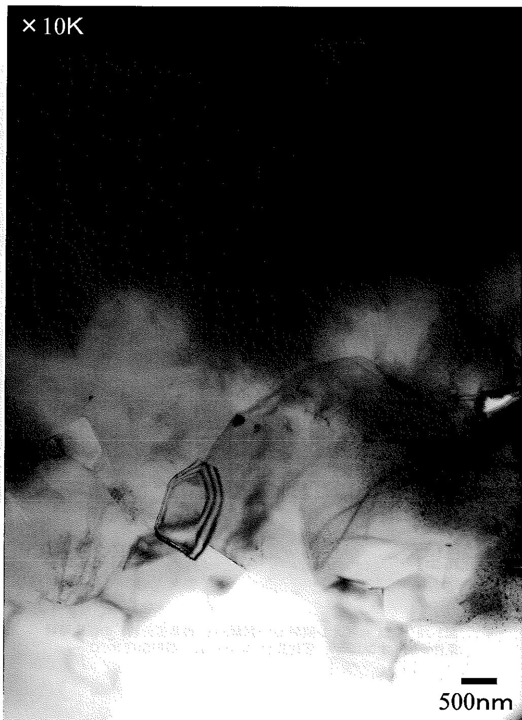
図3-27 高温 Heイオン照射 $B_4C$ （試料5-2、炭素還元粉）の組織照射
