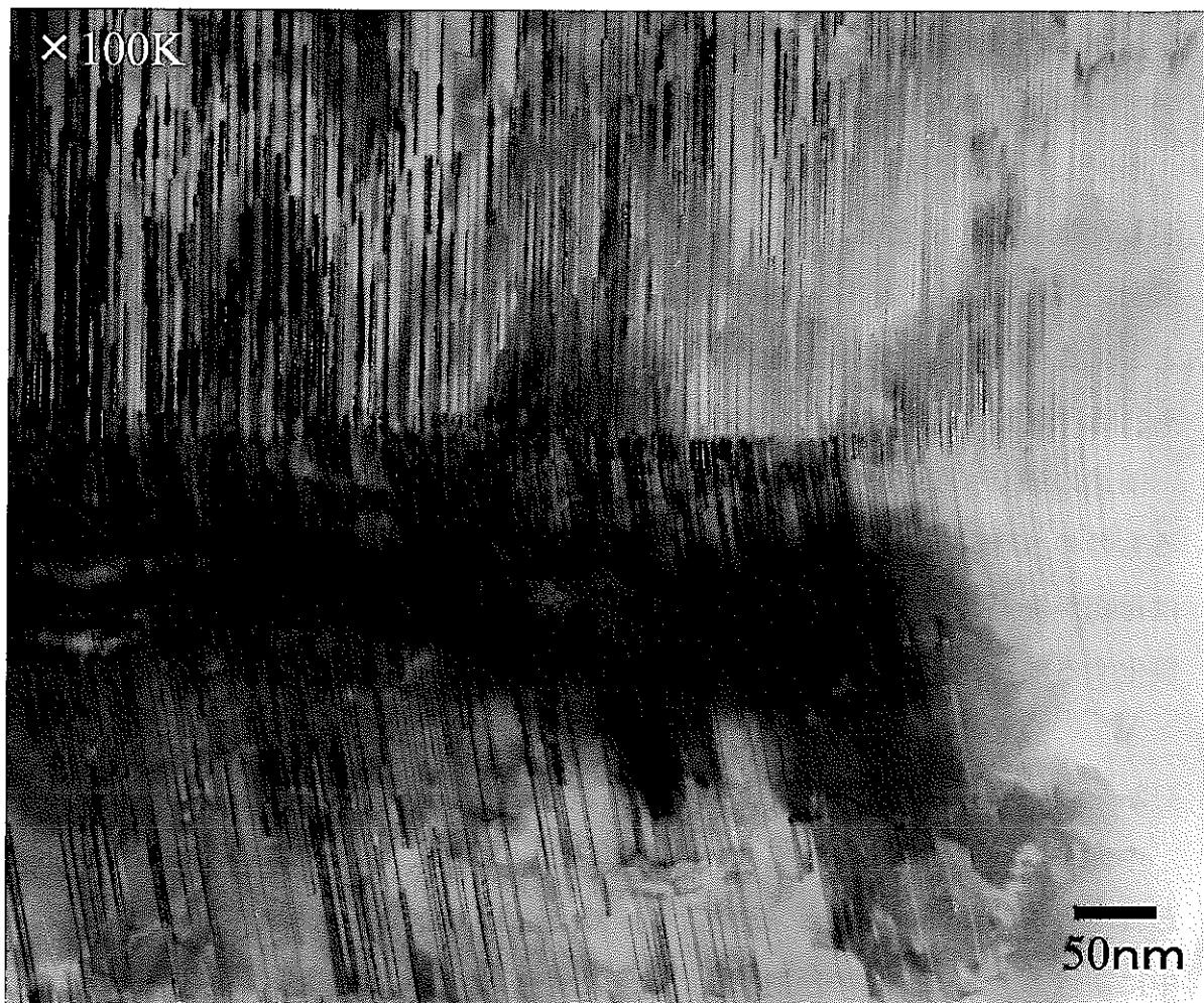
図3-61 イオン照射SiCに追加電子線照射し、600°Cでアニールしたときの組織写真
