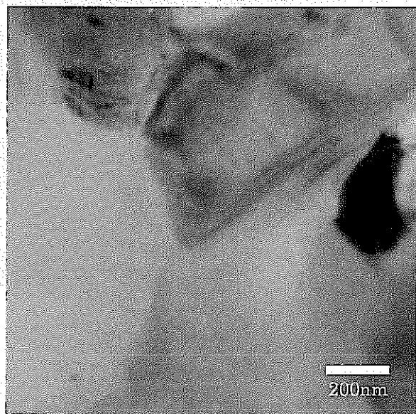
図3-4 炭素還元法B<sub>4</sub>C焼結体の組織写真
