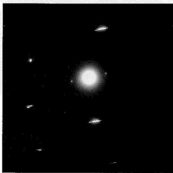
図3-47 Cイオン照射SiC（試料9-3）の組織写真。
