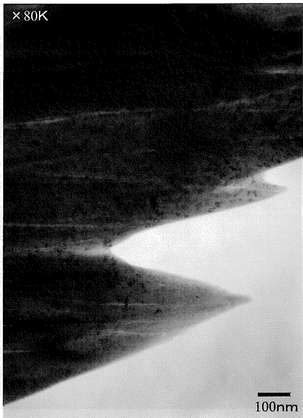
図3-20 Heイオン照射B<sub>4</sub>C（試料3-4、炭素還元粉）の組織
