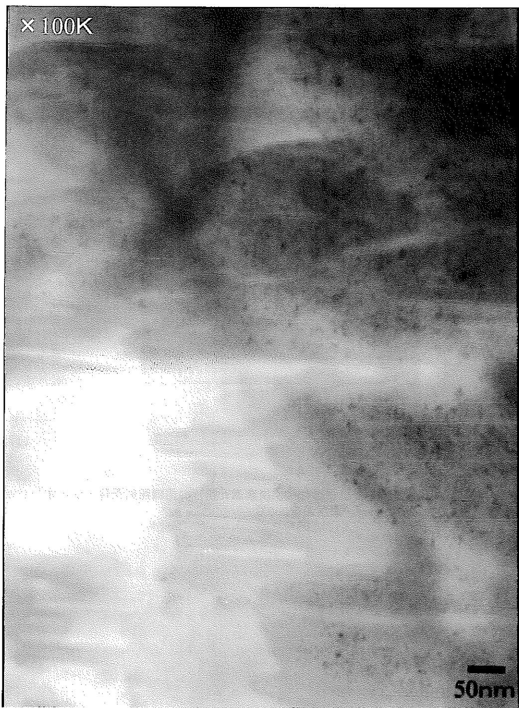
図3-21 Heイオン照射B<sub>4</sub>C（試料3-4、炭素還元粉）の組織照射条件：Heイオン15MeV、
