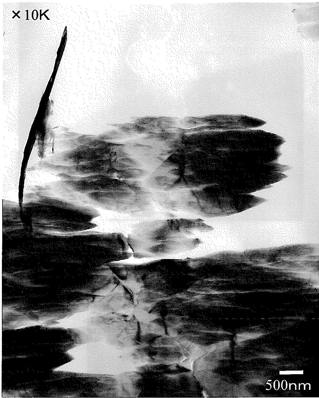
図3-18 Heイオン照射 $B_4C$ （試料3-4、炭素還元粉）の組織
