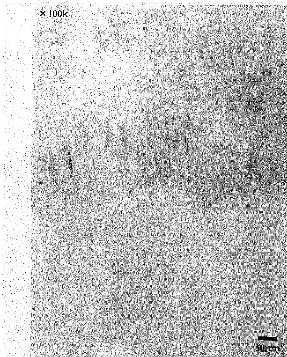
図3-49 Cイオン照射SiC（試料9-3）の組織写真。
