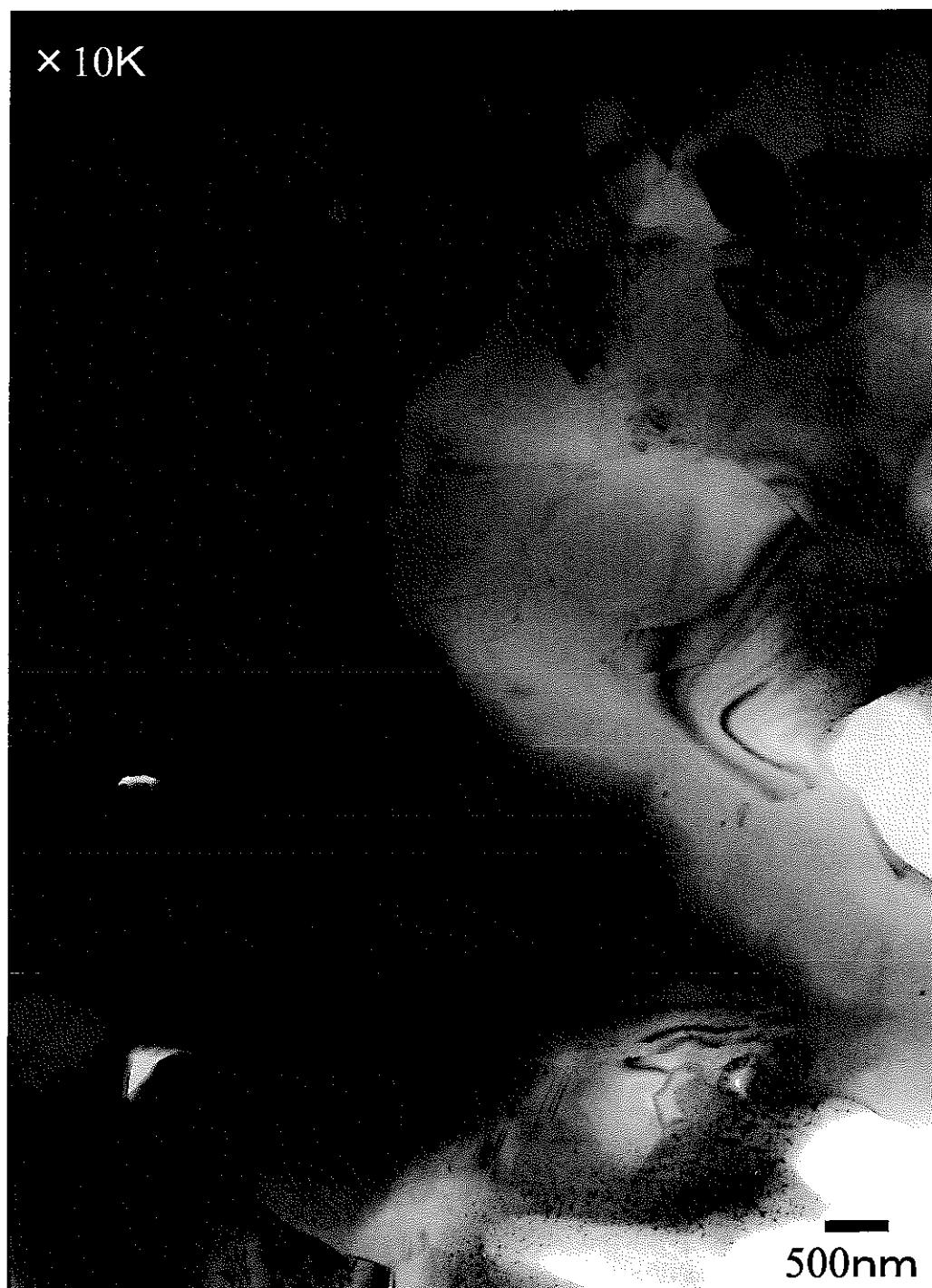
図3-26 高温 Heイオン照射 $B_4C$ （試料5-2、炭素還元粉）の組織照射
