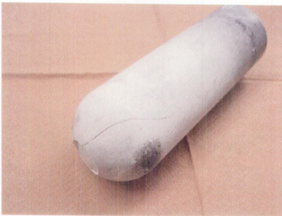
図 3.1 破損したるつぼ
