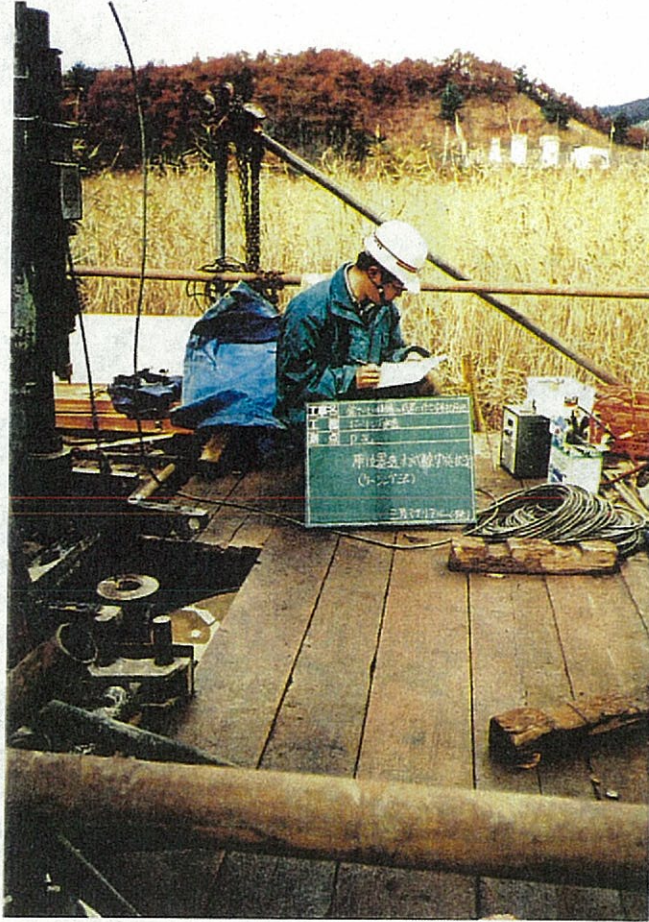
透水試験（ケーシング法） 実施状況
