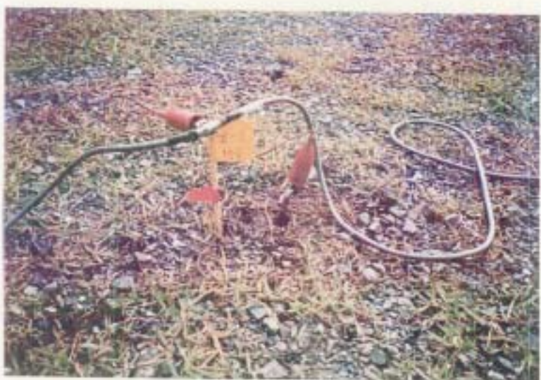
II-1 測線 電極設置状況
