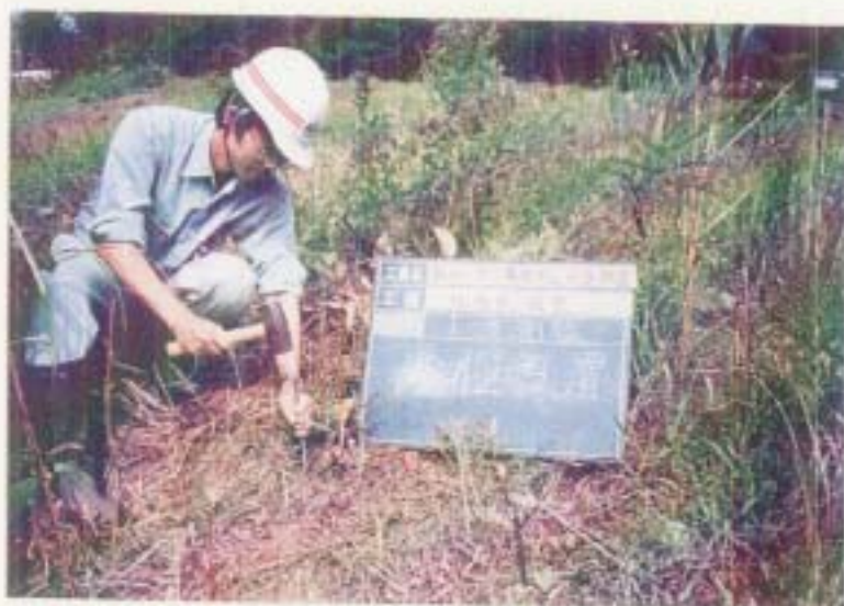
I-3測線 電極設置
