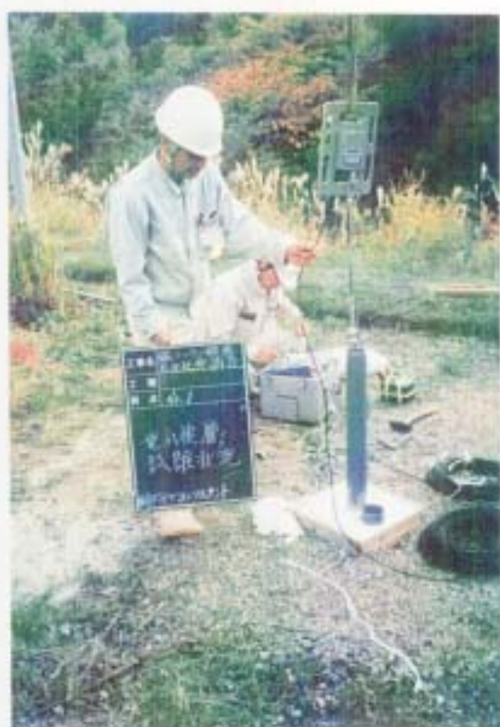
電気検層状況
