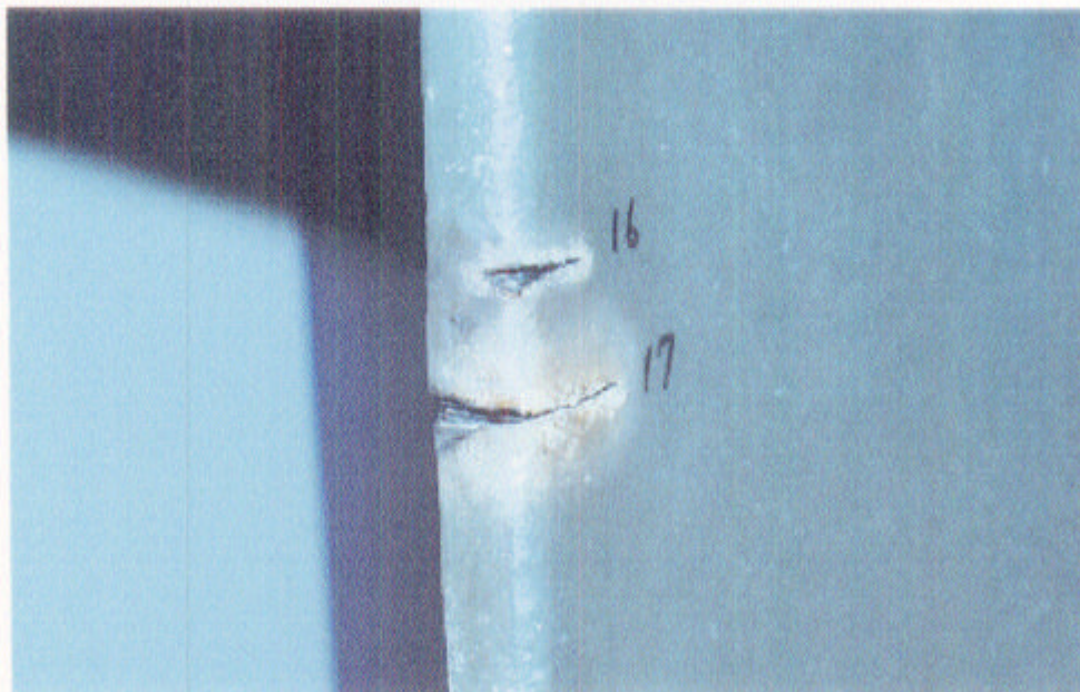
図2. 3. 6 切断試験後の試験片外観(④')
