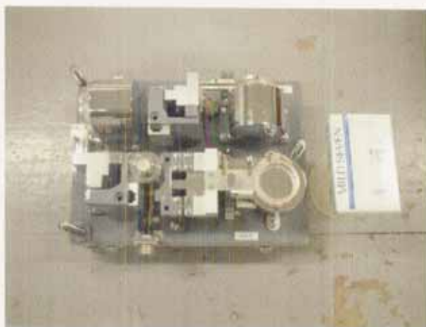
写真4. 1-1 常時微動計測システム (上 増幅器と収録装置兼モニタ, 中 振動センサー 下 振動センサー (蓋を開けた状態))
