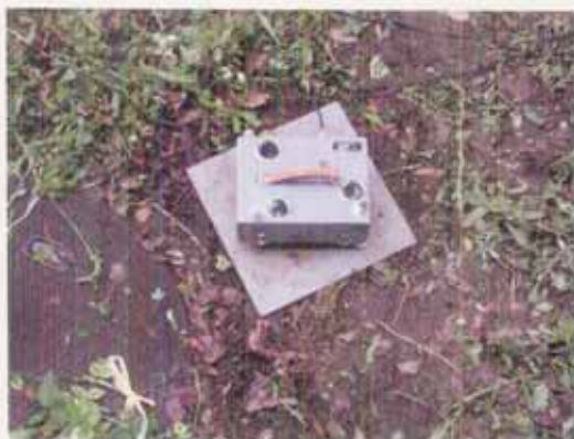
写真4. 1-2 振動センサー設置状況 (設置台上に設置) 写真4. 1-3 振動センサー設置状況
