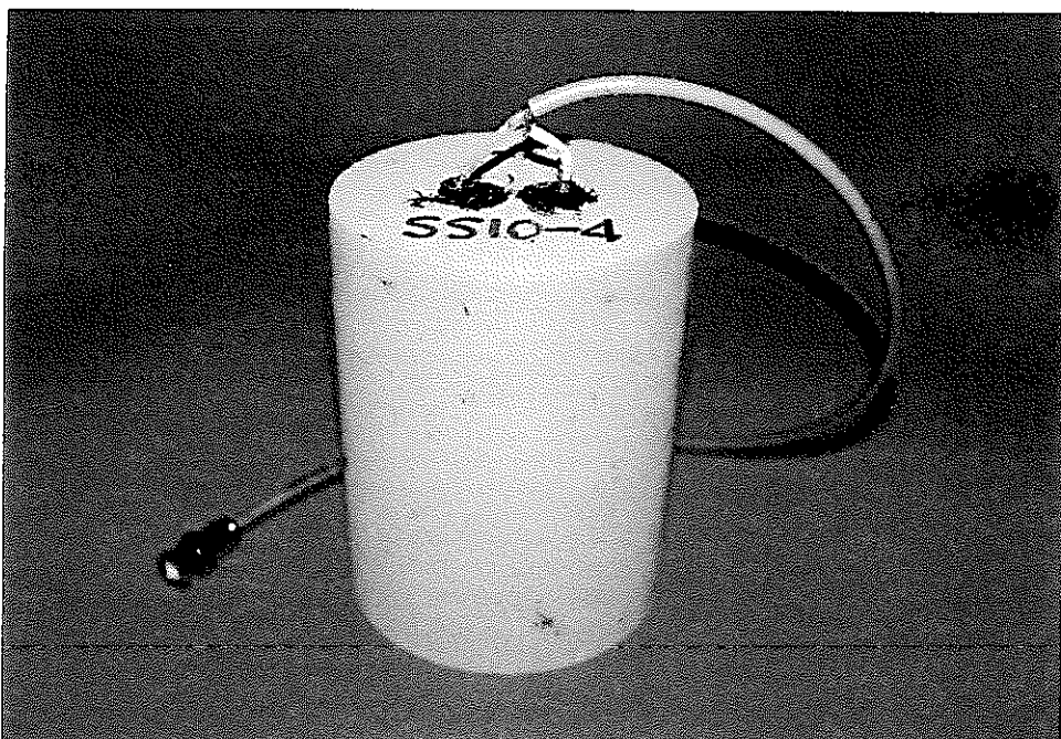
写真 3-2 比誘電率測定に用いた供試体（白川砂岩, SS10-4）
