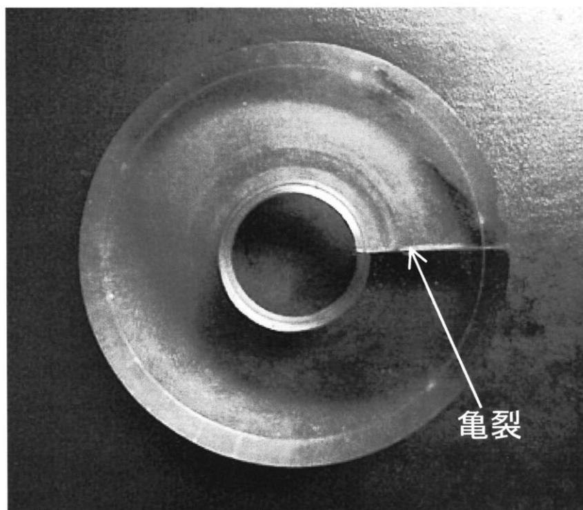
図5-2 アクリル製円筒の破損状況.
