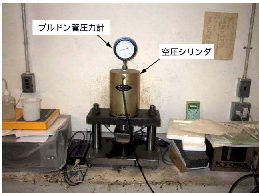
図 2 - 2 空圧クリープ試験機の載荷部
