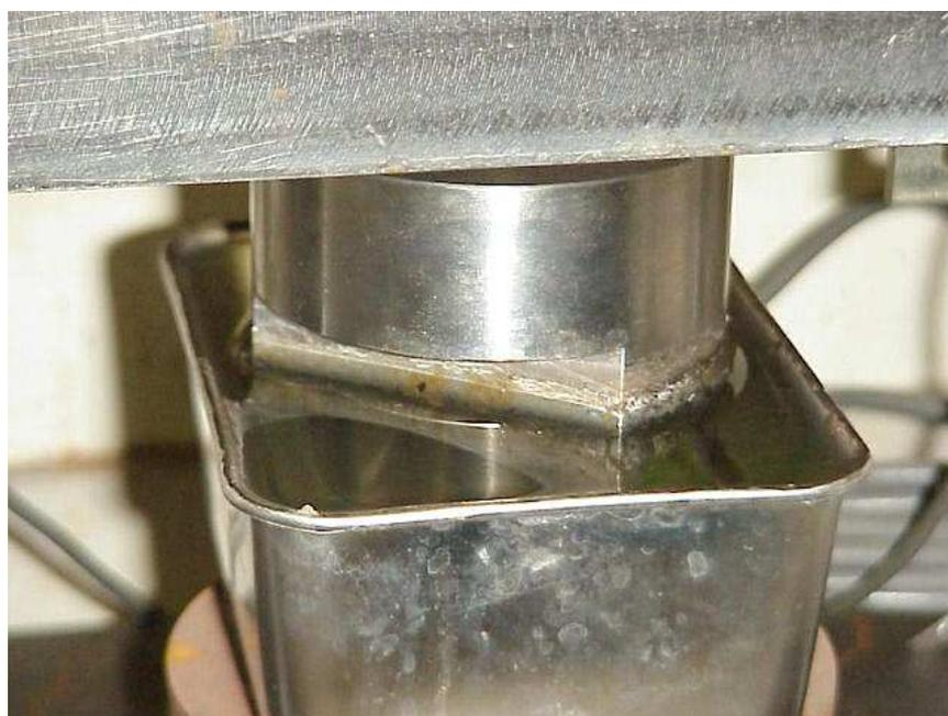
図 2 - 3 空圧クリープ試験機の載荷部の拡大
