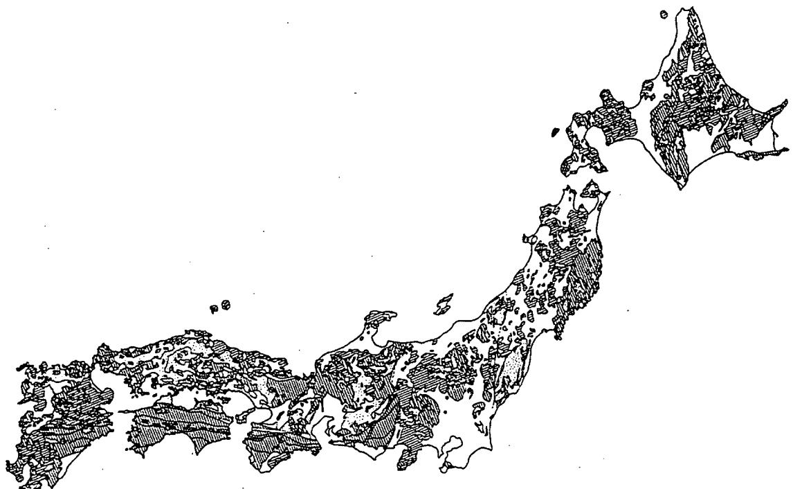
図4.2.3-5 アルカリシリカ反応性骨材の分布図
