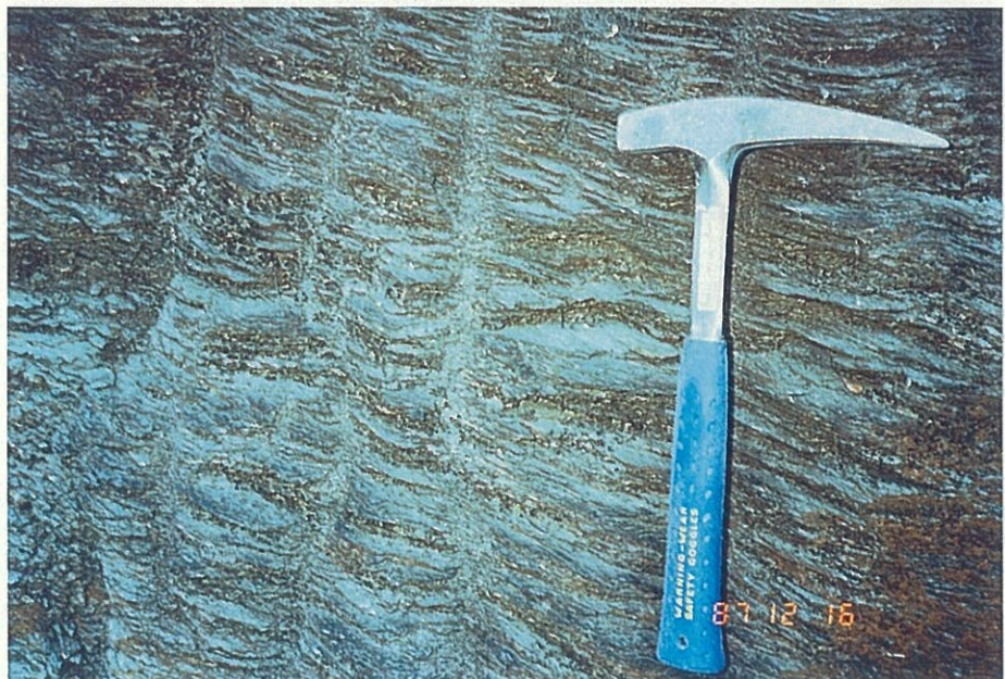
写真6 航空写真解析のユニットSA11 強ハク離性の黒色片岩 (高知県池川町坂本)
