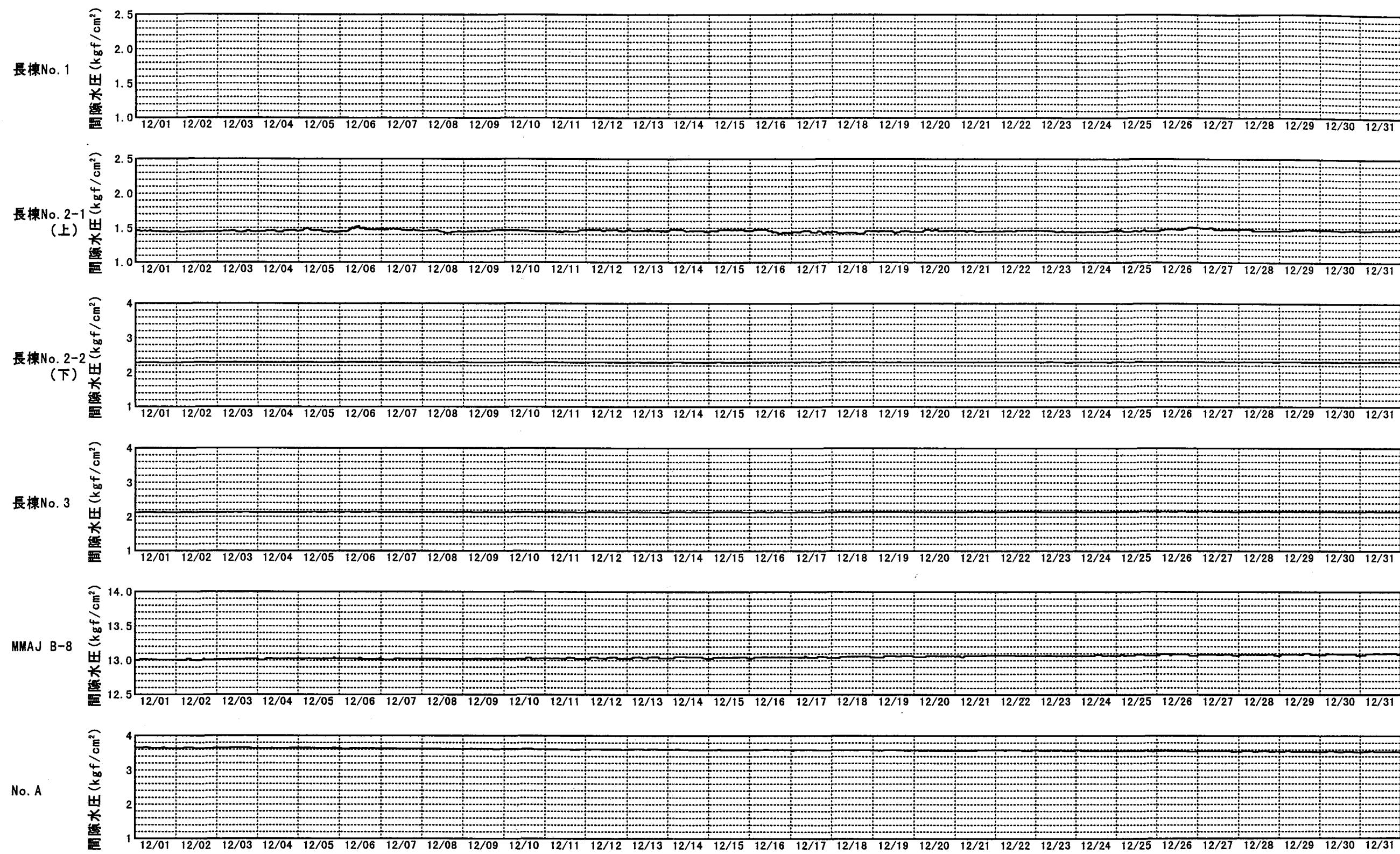
図5.1 間隙水圧観測結果
