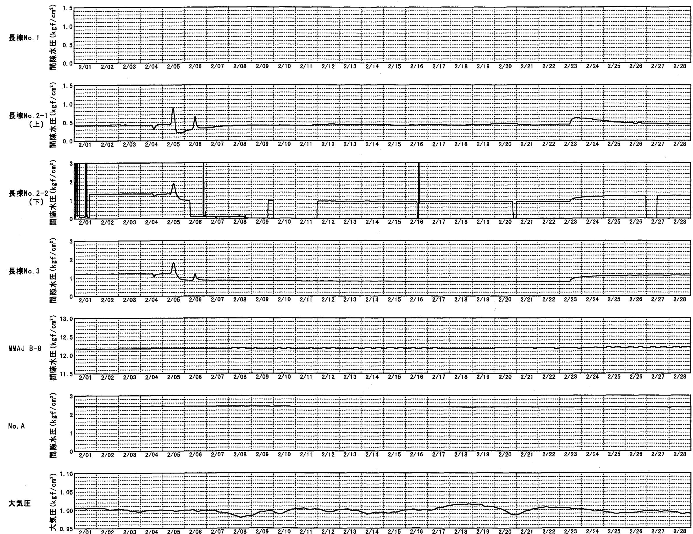
図4.3 間隙水圧・大気圧観測結果(平成10年2月1日～平成10年2月28日)
