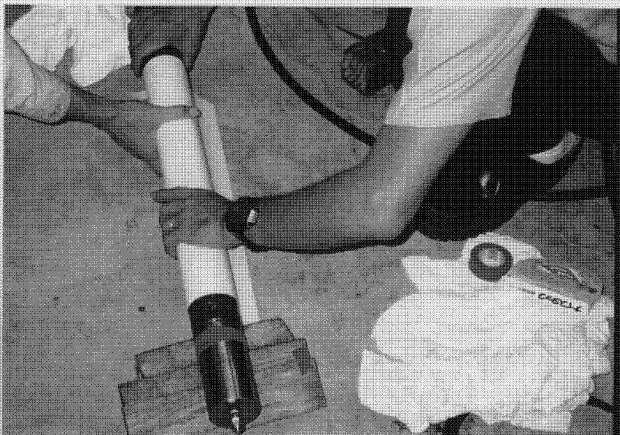
鋼管内载荷による プレスケールでの プローブ挙動把握
