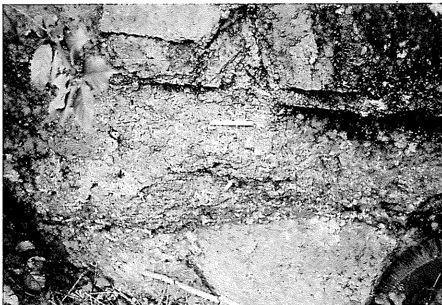
写真-14 同上(比抵抗測定箇所：測点番号2) 写真中央白色部は「たばこ」で、ハンマーの軽い打撃で表面が剥落する
