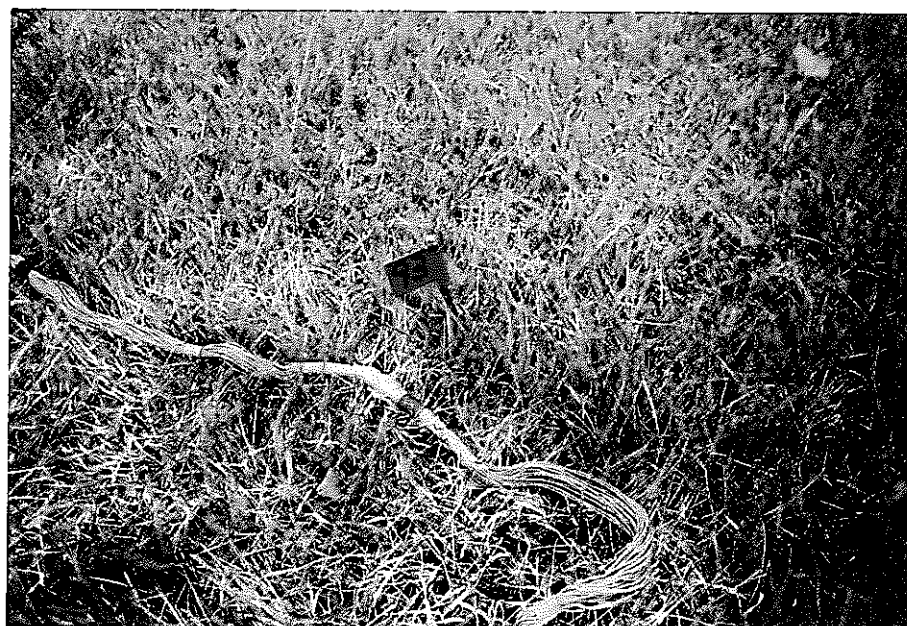
写真-5 電極とケーブルの接続状況
