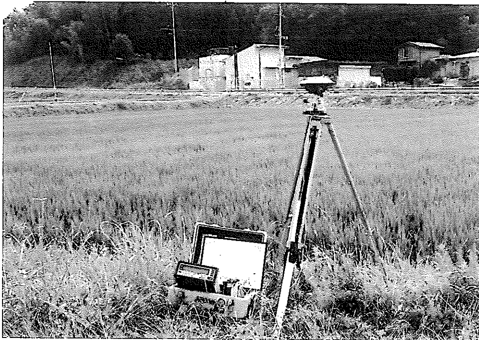
写真-6 受信作業（四等三角点 西野井）
