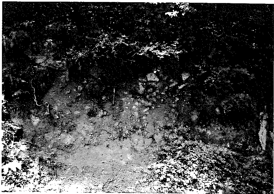
写真11 花崗岩礫よりなる崖錐堆積物 (H061016, 市原南)。主な礫種は花崗岩 (Gr) である。礫形は亜角礫～亜円礫を、球形度は中程度である。礫の最大直径は約 1m である。大部分の花崗岩はマサ化している。基質は赤色粘土である。本露頭の崖錐堆積物は基質支持 (マトリックスサポート) である。礫の配列状態は特に見られない。露頭面はほぼ垂直である。ハンマーの長さ約 30cm。
