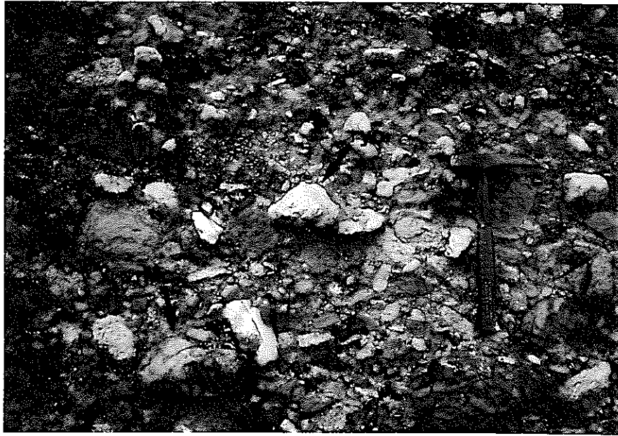
写真10 瀬戸層群 (O052001, 松野湖東)。礫種は白色流紋岩礫 (ryo.) や暗灰色チャート礫 (Mc) などである。礫形は垂円礫～円礫を呈し、球形度は中程度である。基質は茶色シルトである。本露頭の瀬戸層群は礫支持 (クラストサポート) である。礫の配列状態は特に見られない。露頭面はほぼ垂直である。ハンマーの長さ約 30cm。
