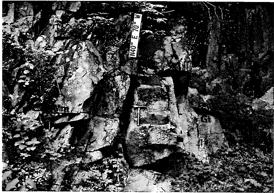
写真16 美濃帯泥岩 (Mm) - 土岐花崗岩 (Gt) 境界 (H061022, 市原東)。矢印は境界の位置。土岐花崗岩の粒度は細～中粒である。
