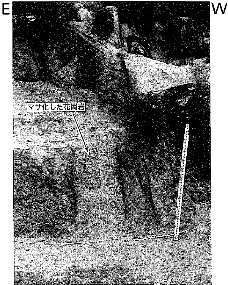
写真 2 1 破碎帯に沿ってマサ化した粗粒花崗岩 (0073001, 松野湖東)。薄赤茶部分がマサ化した花崗岩。
