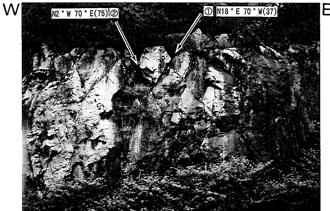
写真19 2方向の割れ目が卓越した粗粒花崗岩 (0060401, 大湫)。矢印は①および②の代表的な割れ目を示す (カッコ内の数字は資料2にある割れ目の通し番号)。ハンマーの長さ約30cm。
