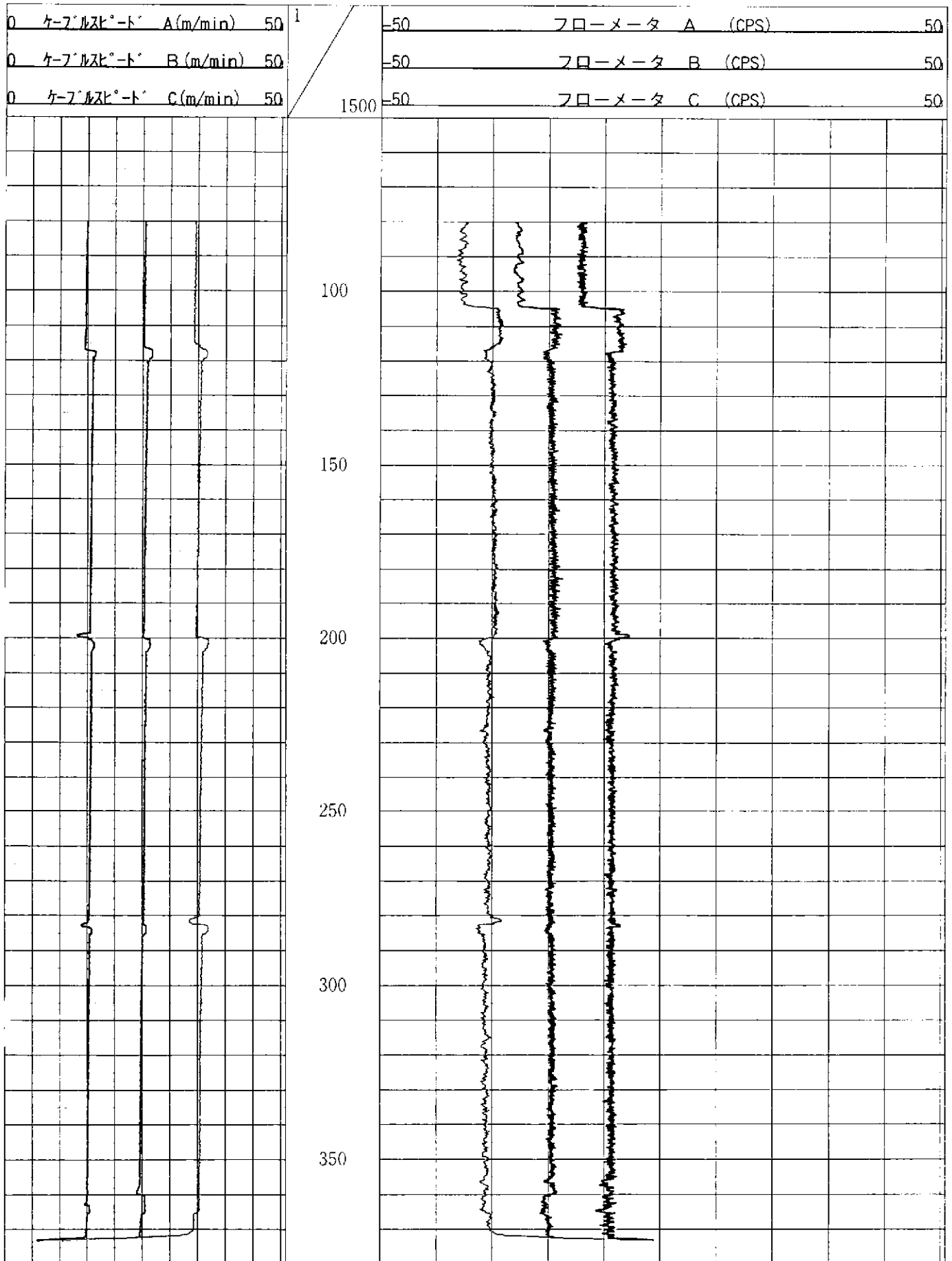
図 5.3.17 フローメータ一検層図(2次測定, 揚水 46.2 ℓ/min.:UP)
