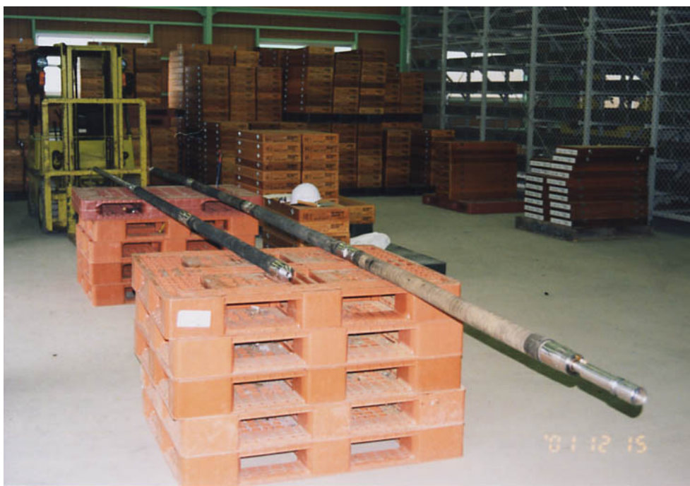
写真-4.6.3 パッカー組立（第1回試験）
