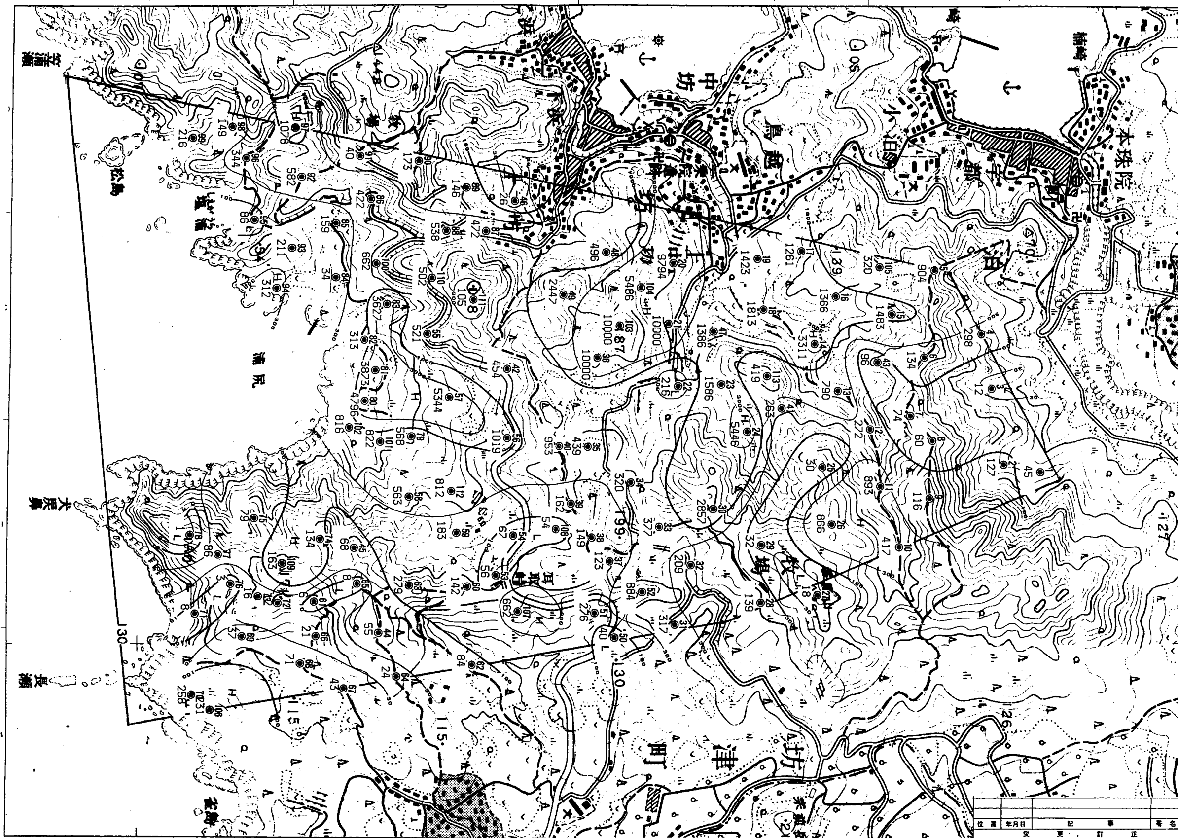
図-10-2 見掛比抵抗平面図 (180Hz) (E-W 電極配置)
