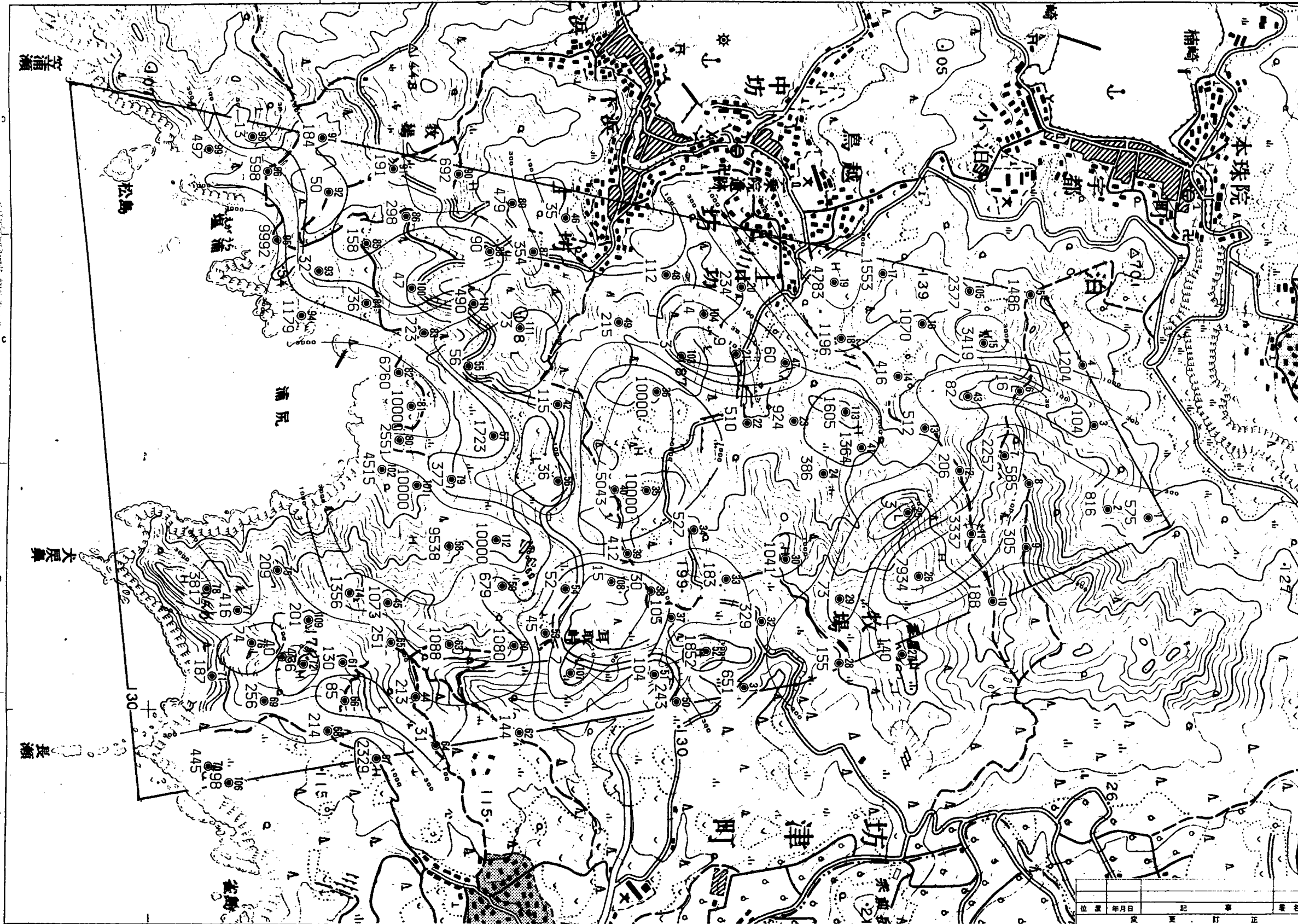
図-11-1 見掛比抵抗平面図 (60Hz) (N-S 電極配置)
