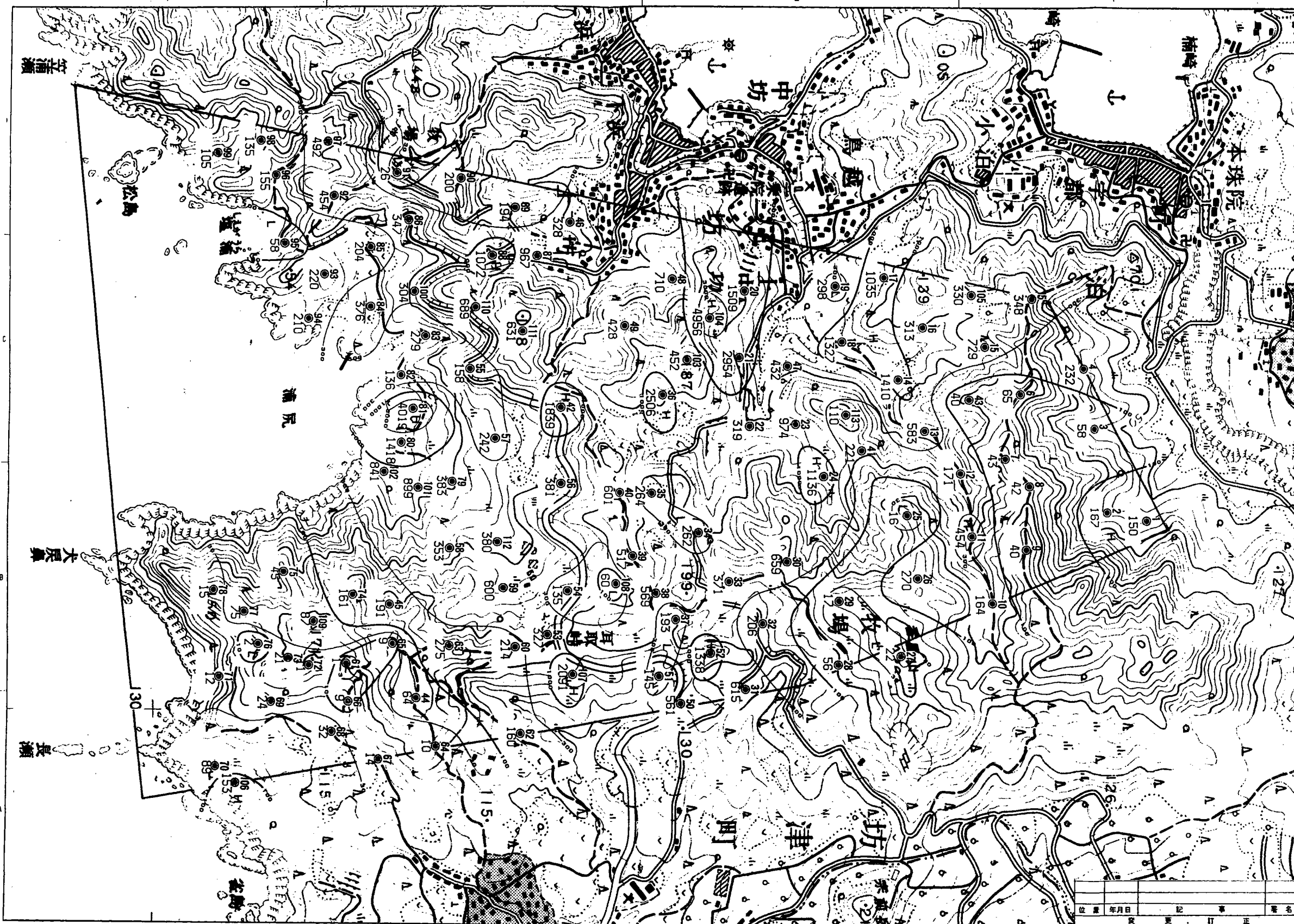
図-10-3 見掛比抵抗平面図 (300Hz) (E-W 電極配置) 製作 (日本誠業株式会社)
