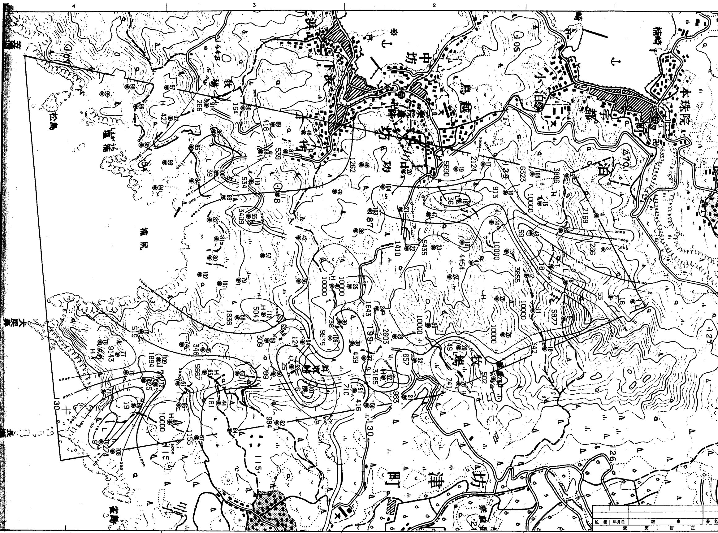
図-13-1 比抵抗構造平面図 (50m S.L. 平面) 製作 (日本鉱業株式会社)
