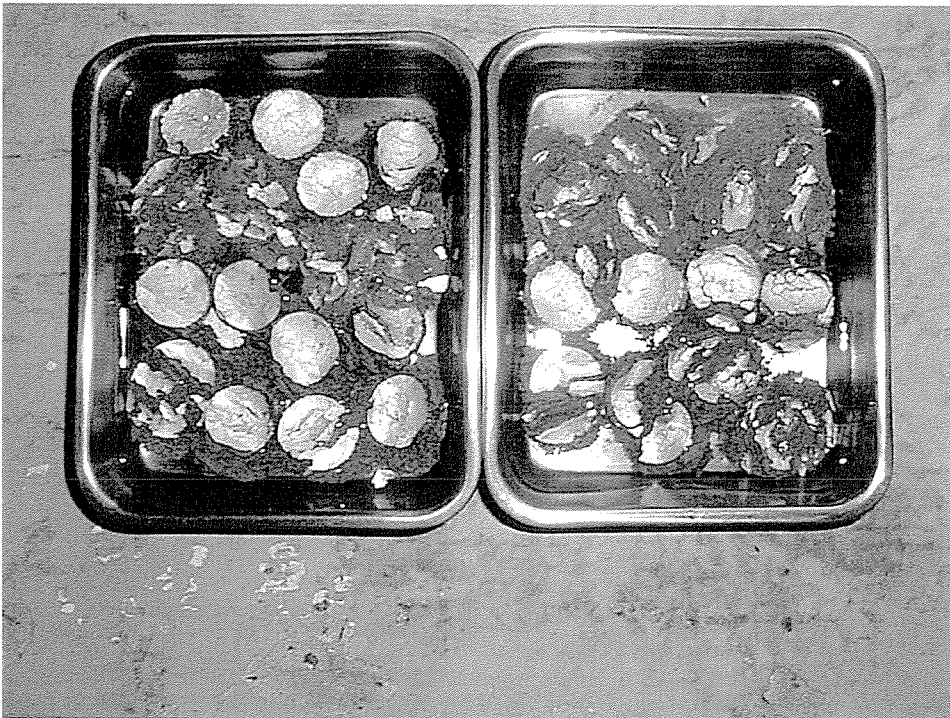
コア崩壊状況（湿潤 4～5 分後）
