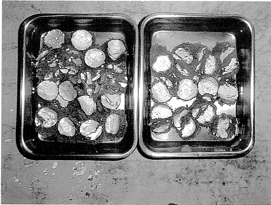
コア崩壊状況（湿潤 1～2 分後）
