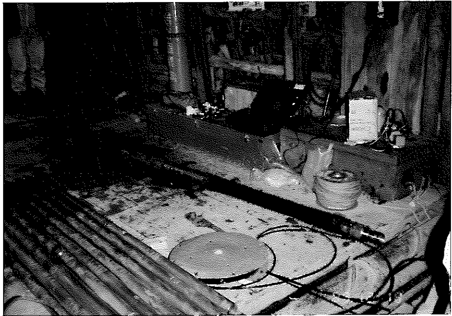
引上げ後のパッカー
