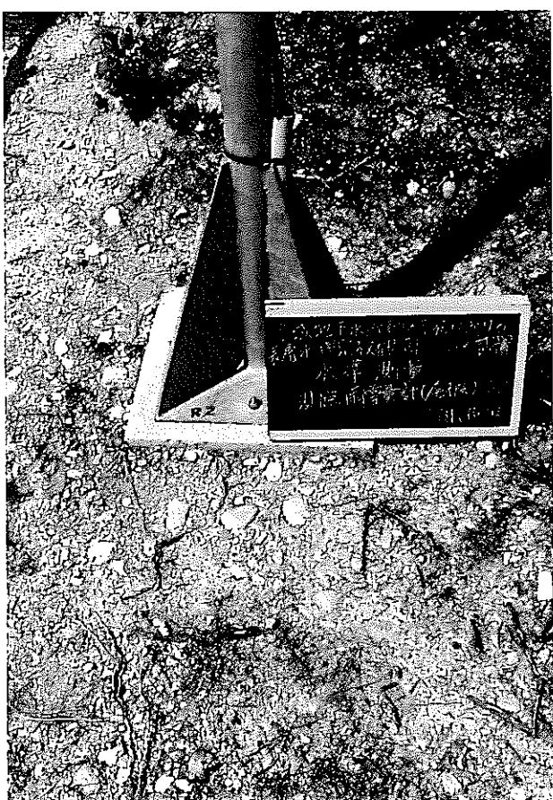
水準測量の測点（尾根の雨雪量計足元）
