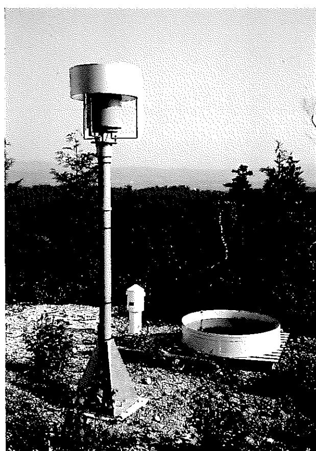
雨雪量計および蒸発計
