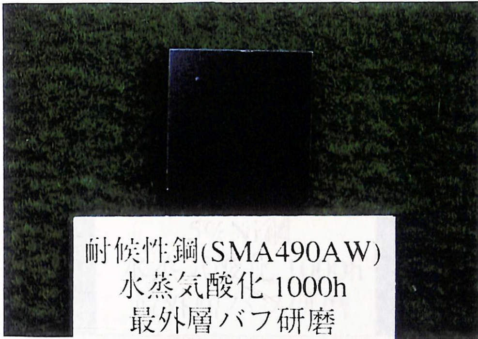
写真3.3-3 水蒸気酸化した耐候性鋼の最外層バフ研磨材の試験片写真 (SMA490AW, 1000h水蒸気酸化処理, 最外層バフ研磨材)
