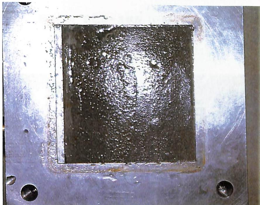
図3-9 自己シール状況 (Ca型化空隙5%)
