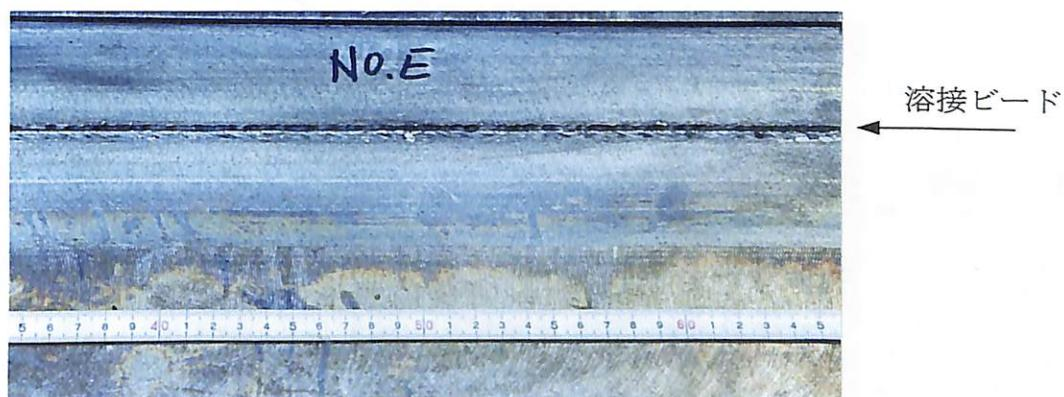
図 3.3-3 電子ビーム溶接部の外観写真
