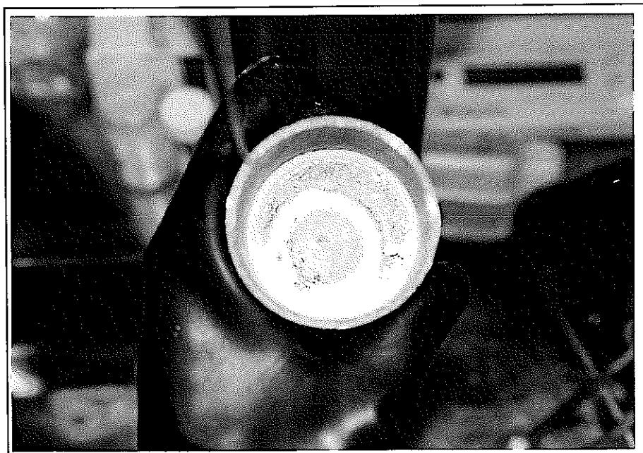
写真 22 Run No.6 るつぼ設置治具溶融塩噴出痕跡
