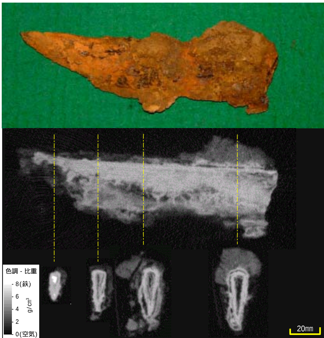
圖4.2.1-5 X線C T撮像結果（試料1-5/刀身先端/鉄質残存）
