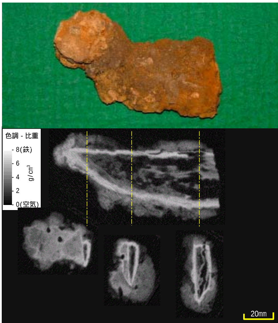
図4.2.1-8 X線C T撮像結果（試料1-8/刀身先端/全て錆化）
