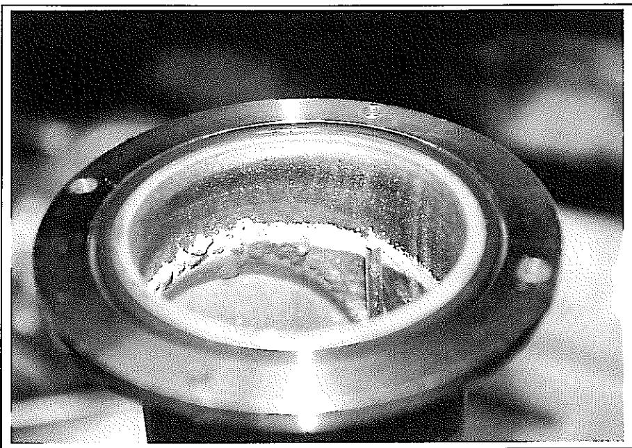
写真 34 Run No.10(NaCl-CsCl-B<sub>2</sub>O<sub>3</sub>試料条件)処理容器上部状況
