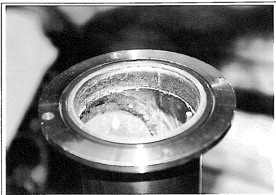
写真 6 Run No.11(CsCl-B<sub>2</sub>O<sub>3</sub>試料条件)処理容器上部状況
