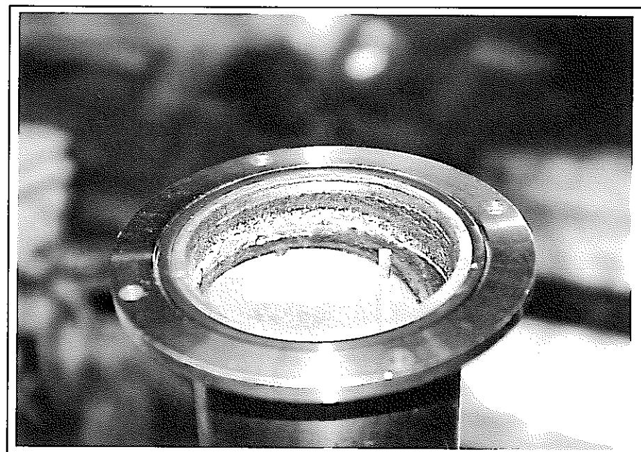
写真 20 Run No.13(NaCl-CsCl-B<sub>2</sub>O<sub>3</sub> 試料条件)処理容器上部状況
