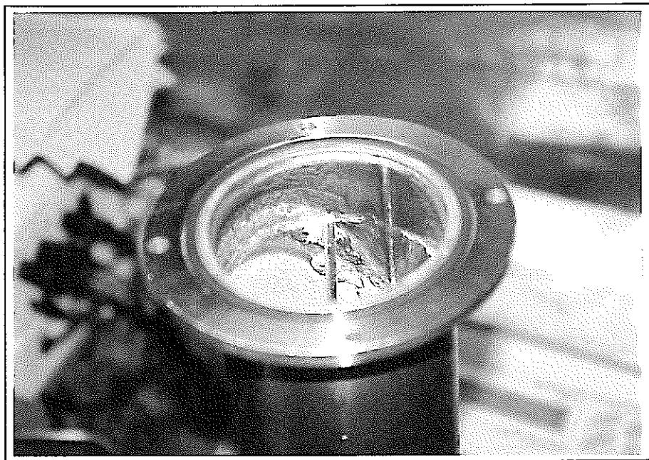
写真 8 Run No.15(CsCl-B<sub>2</sub>O<sub>3</sub>試料条件)処理容器上部状況
