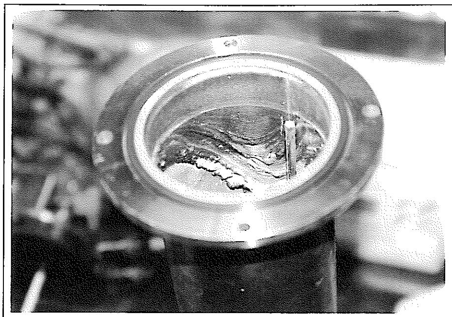
写真 26 Run No.24(NaCl-CsCl-B<sub>2</sub>O<sub>3</sub> 試料条件)処理容器上部状況
