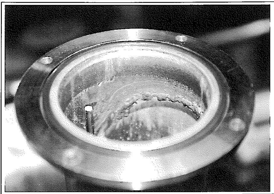
写真 10 Run No.3(CsCl-B<sub>2</sub>O<sub>3</sub>試料条件)処理容器上部状況
