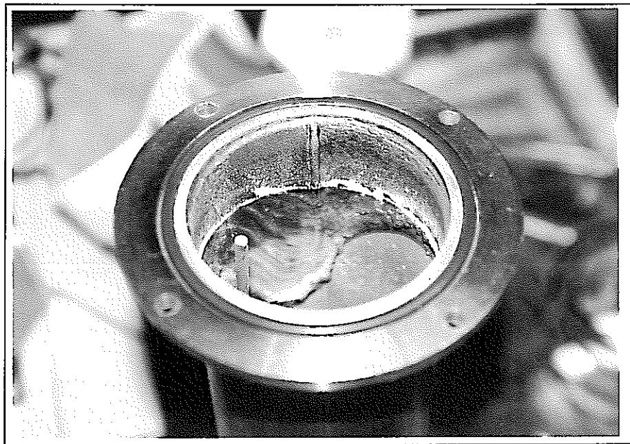
写真 16 Run No.7(NaCl-CsCl-B<sub>2</sub>O<sub>3</sub> 試料条件)処理容器上部状況
