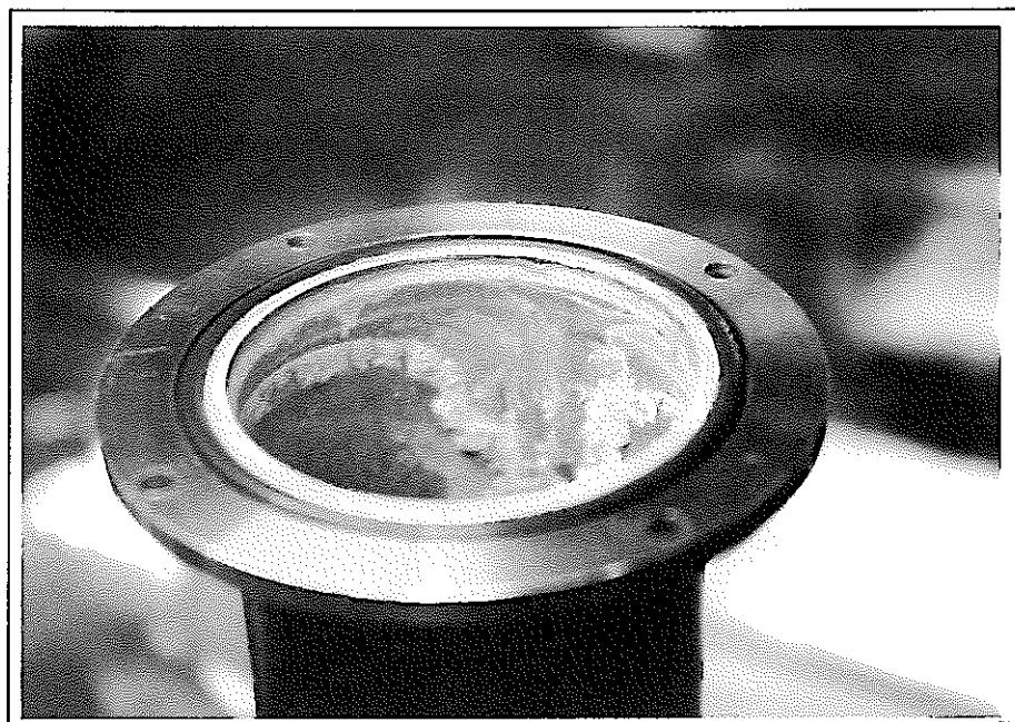
写真 46 Run No.17(CsCl-B<sub>2</sub>O<sub>3</sub>-ハイドロソーダライト試料条件)処理容器上部状況
