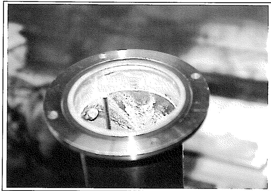
写真 36 Run No.14(NaCl-CsCl-B<sub>2</sub>O<sub>3</sub>試料条件)処理容器上部状況
