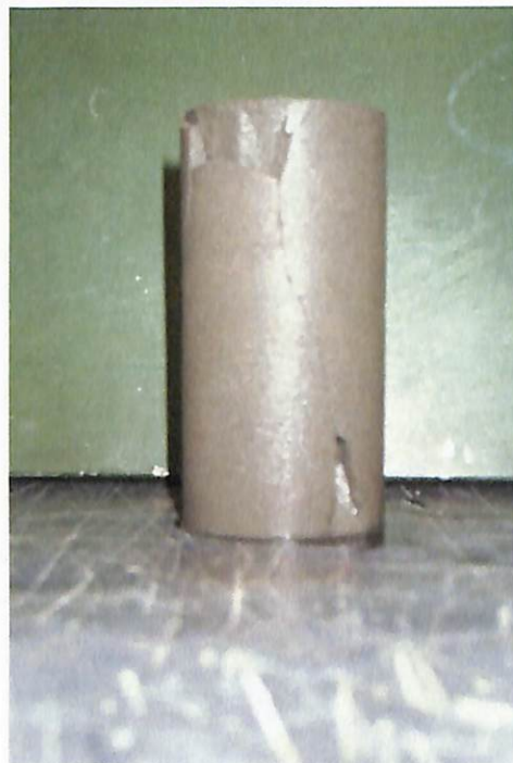
歪み速度繰返し一軸圧縮試験 Y-5 供試体破壊状況②
