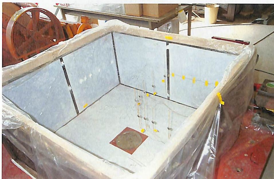
模型実験載荷装置 土圧計設置状況
