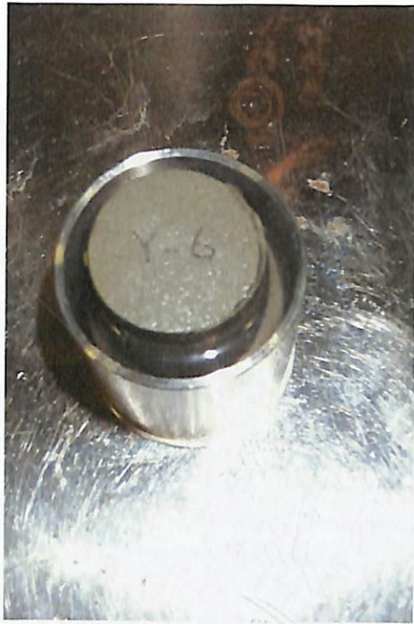
歪み速度繰返し一軸圧縮試験 Y-6 供試体破壊状況①
