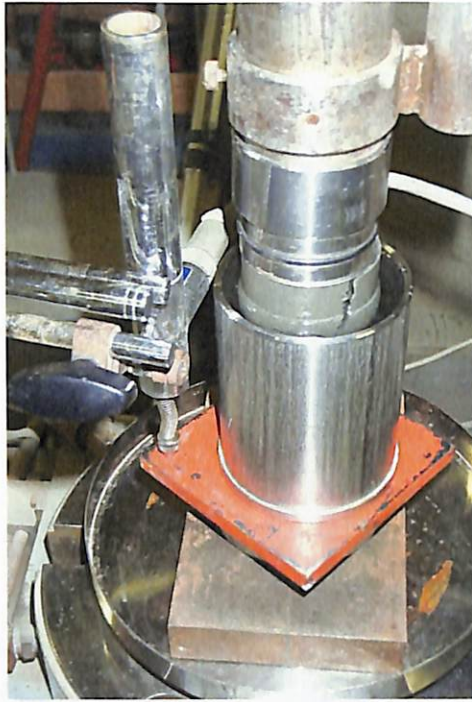
歪み速度繰返し一軸圧縮試験 Y-5 供試体破壊状況①
