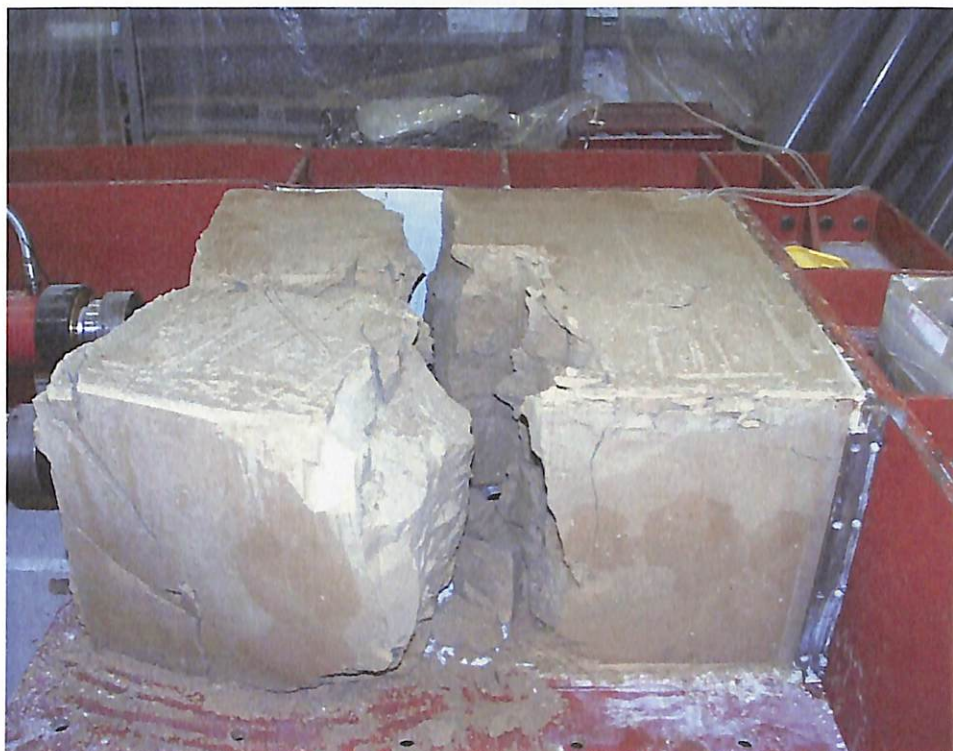
模型実験載荷装置 供試体解体状況
