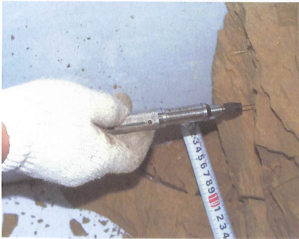
模型実験載荷装置 針貫入試験状況②
