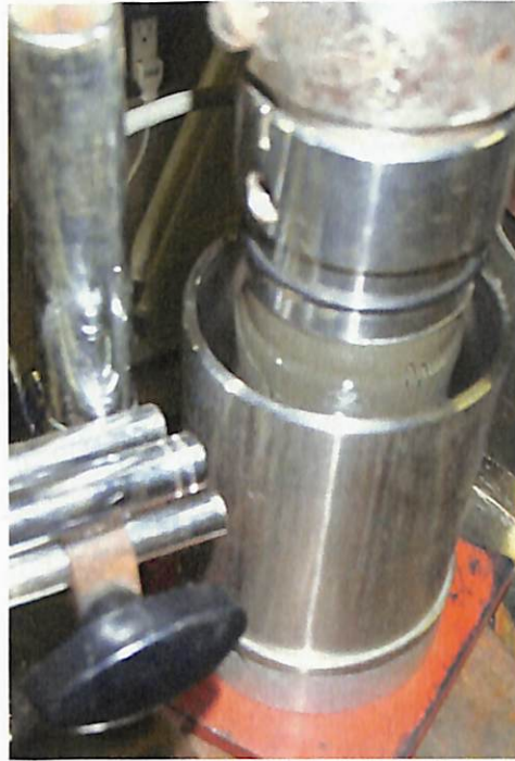
歪み速度繰返し一軸圧縮試験 Y-8 供試体破壊状況①
