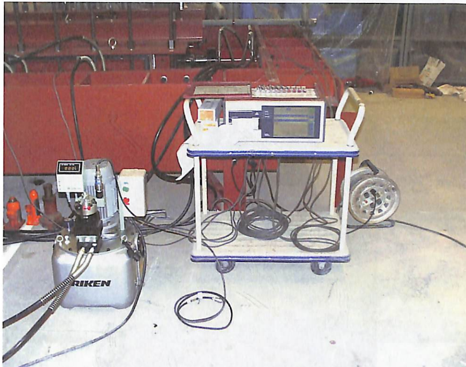
模型実験載荷装置 油圧ポンプおよび記録装置
