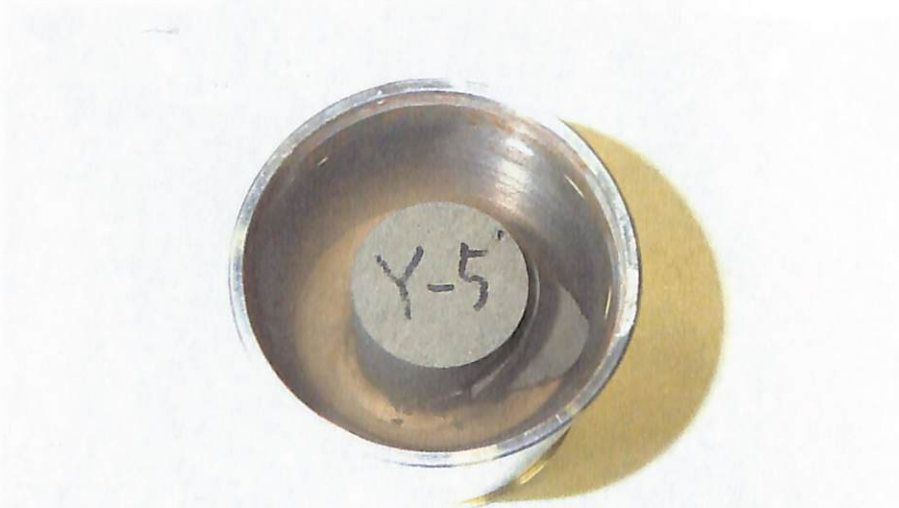
クリープ試験（超短期：想定破壊時間 5 分） Y-5'供試体破壊状況
