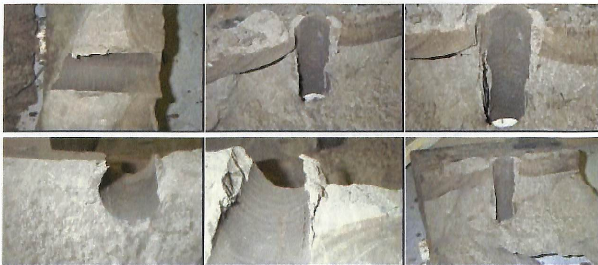
参考写真 珪藻泥岩を用いたトンネル掘削実験
