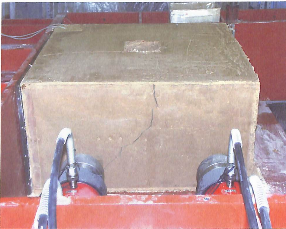
模型実験載荷装置 最終載荷・供試体破壊後（側面 B）
