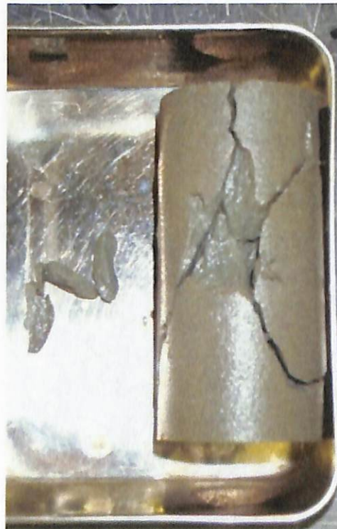
歪み速度繰返し一軸圧縮試験 Y-8 供試体破壊状況②
