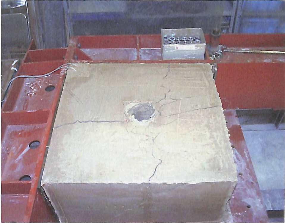
模型実験載荷装置 最終載荷・供試体破壊後
