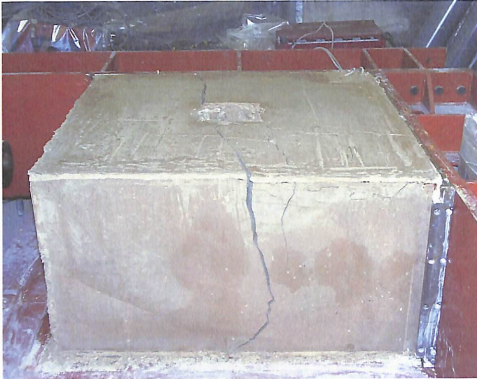
模型実験載荷装置 最終載荷・供試体破壊後（側面 A）
