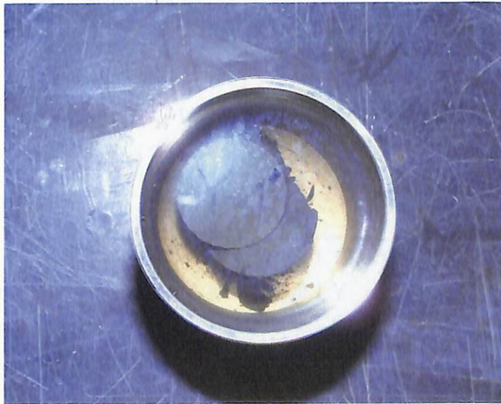
クリープ試験（短期：想定破壊時間 1 日） Y-4'供試体破壊状況
