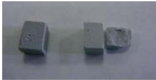
写真3.2 BL-500(角柱状試料)の破断面写真
