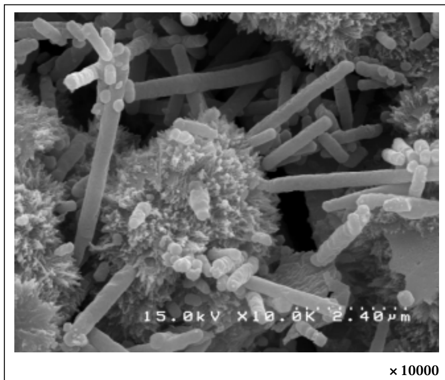
写真3.9 L-500(角柱状試料)の表層部SEM写真
