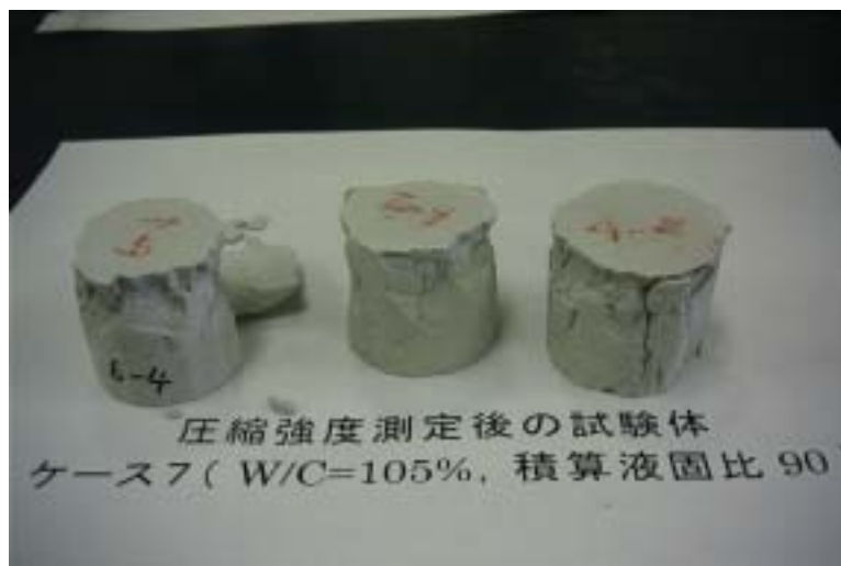
図 3-16 ケース7 ( W/C=105%, 積算液固比 90 ) の圧縮強度測定後供試体
