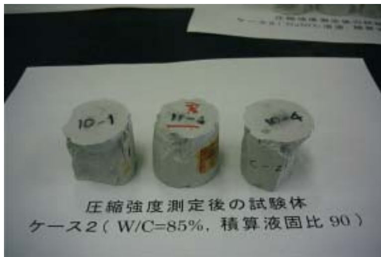
図 3-14 ケース 2 ( W/C=85% , 積算液固比 90 ) の圧縮強度測定後供試体
