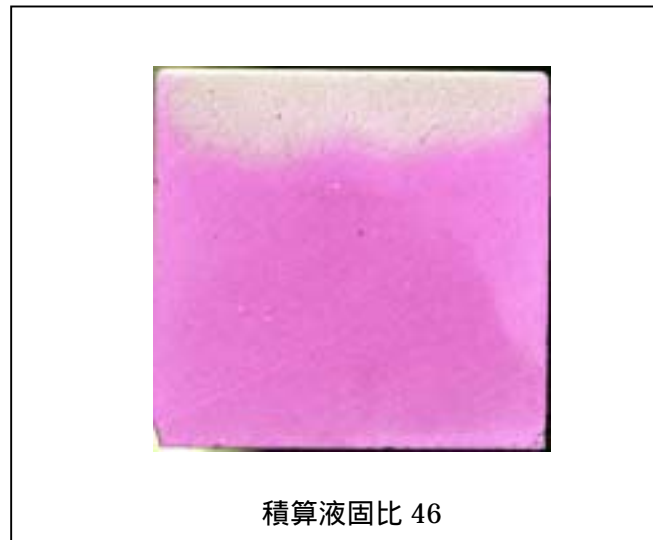
図 3-4 W/C=85%通水後試験体切断面の状況（フェノールフタレイン溶液塗布）
