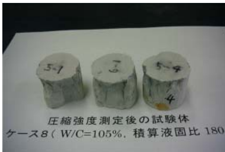
図 3-17 ケース8 ( W/C=105%, 積算液固比 180 ) の圧縮強度測定後供試体
