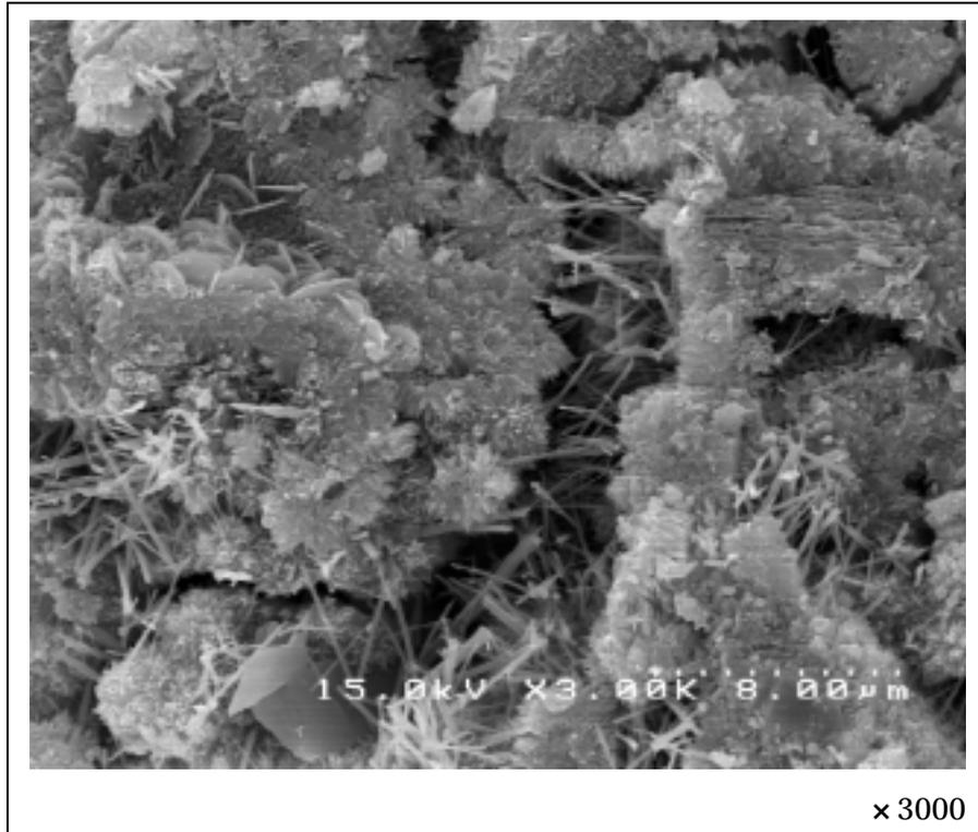
写真3.1 BL-500(角柱状試料)の表層部SEM写真
