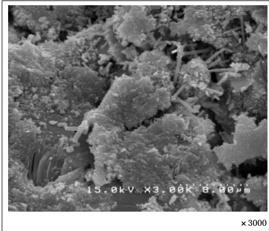
写真3.3 L-500(角柱状試料)の表層部SEM写真
