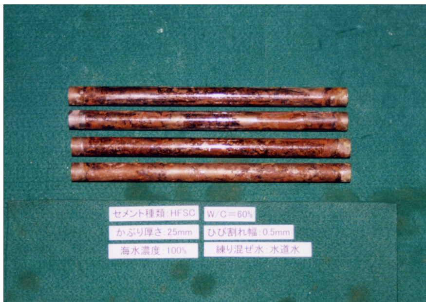
添付写真 1.21 脱錆前 (HFSC W/C=60%)
