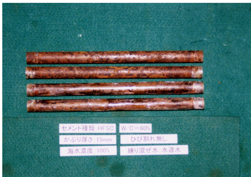
添付写真 1.9 脱錆前 (HFSC W/C=60%)
