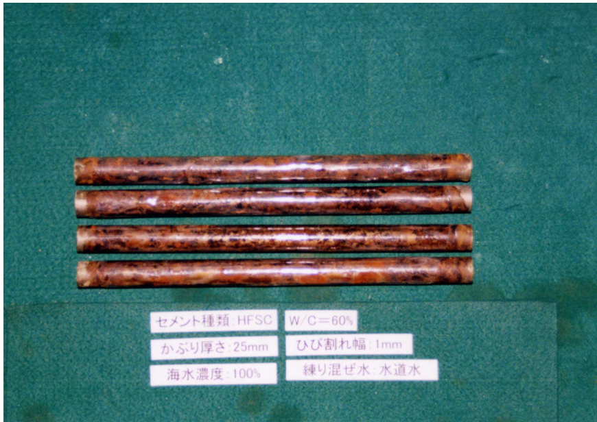
添付写真 1.61 脱錆前 (HFSC W/C=60%)
