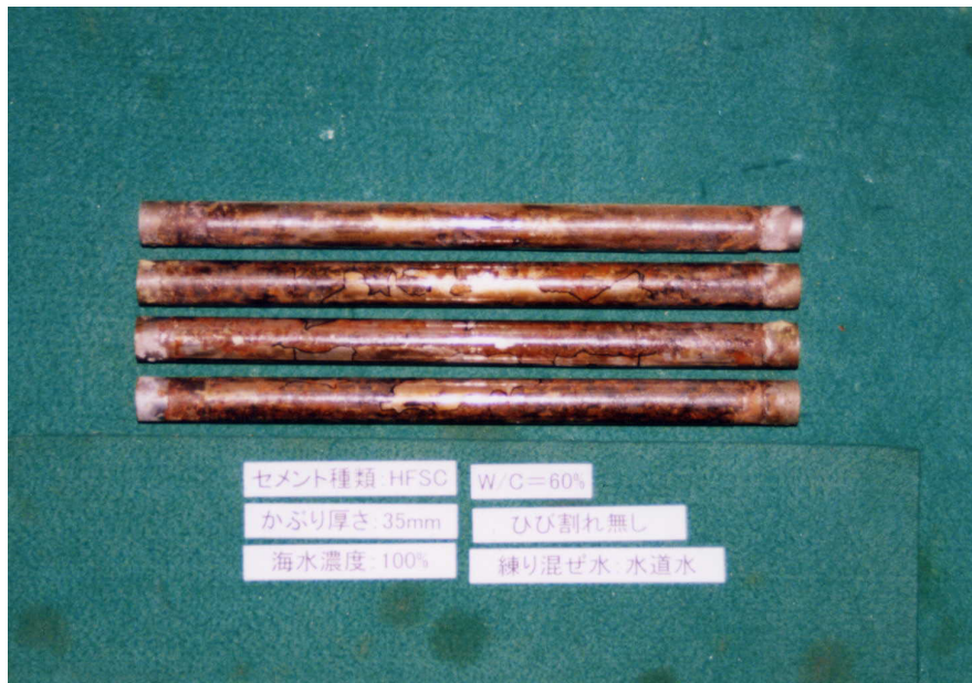
添付写真 1.29 脱錆前 (HFSC W/C=60%)
