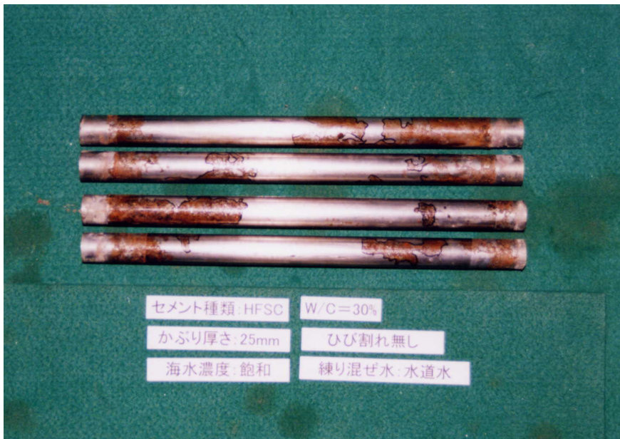
添付写真 1.71 脱錆前 (HFSC W/C=30%)
