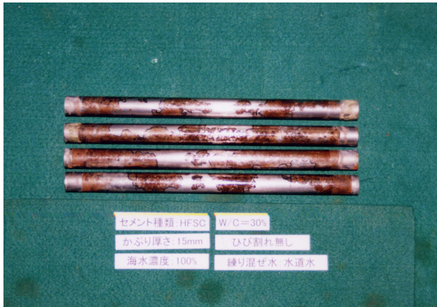
添付写真 1.7 脱錆前 (HFSC W/C=30%)
