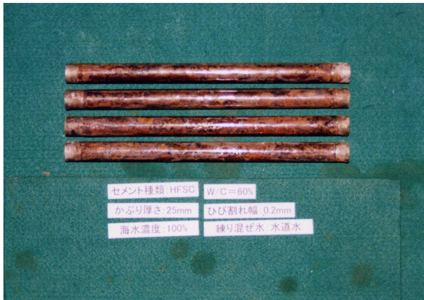
添付写真 1.53 脱錆前 (HFSC W/C=60%)
