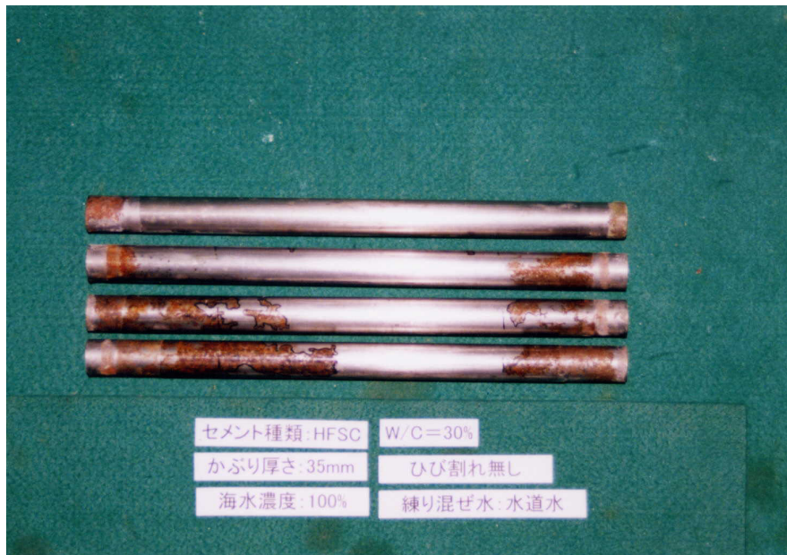
添付写真 1.28 脱錆前 (HFSC W/C=30%)
