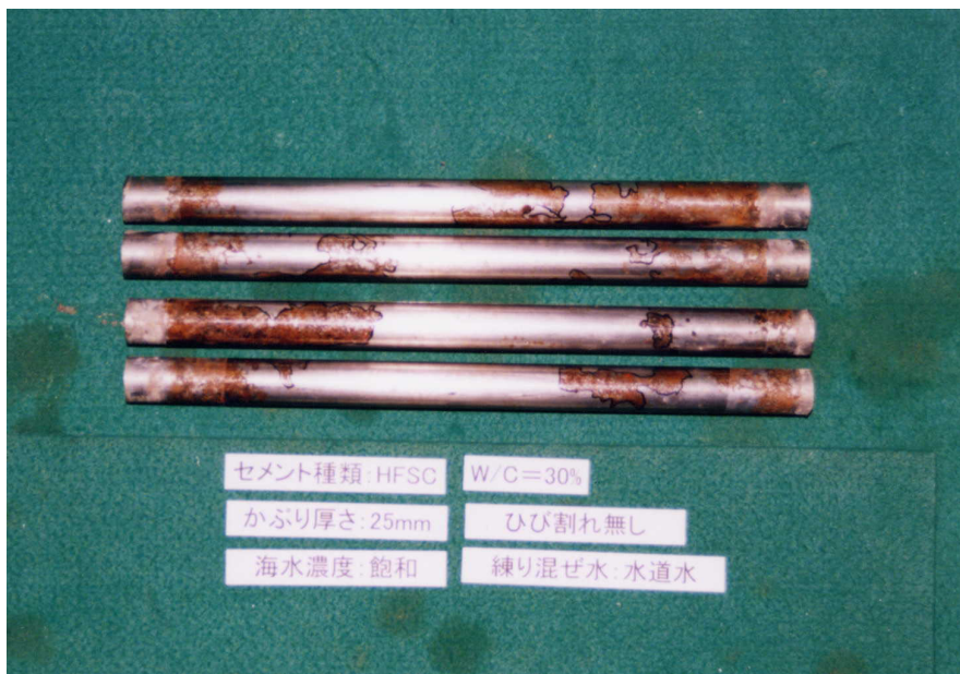
添付写真 1.35 脱錆前 (HFSC W/C=30%)
