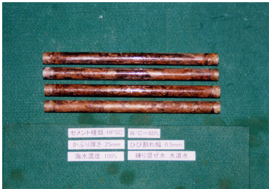
添付写真 1.57 脱錆前 (HFSC W/C=60%)
