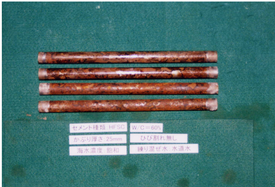
添付写真 1.73 脱錆前 (HFSC W/C=60%)
