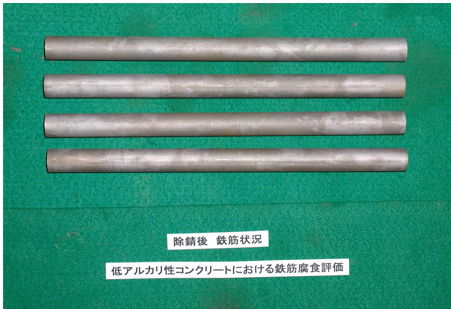
添付写真 1-75 脱錆後の鉄筋の状況
