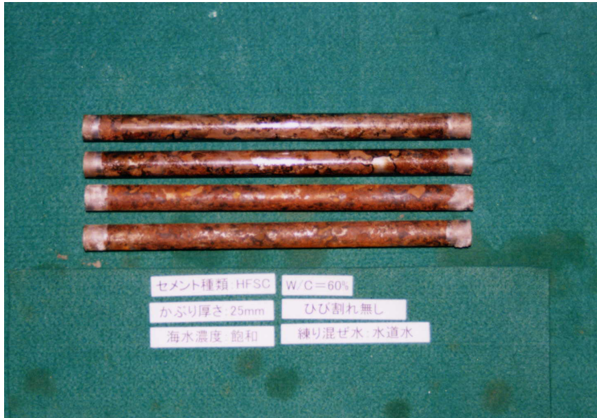
添付写真 1.37 脱錆前 (HFSC W/C=60%)
