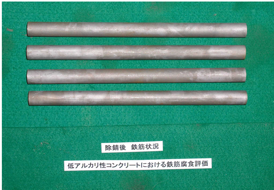
添付写真 1-74 脱錆後の鉄筋の状況
