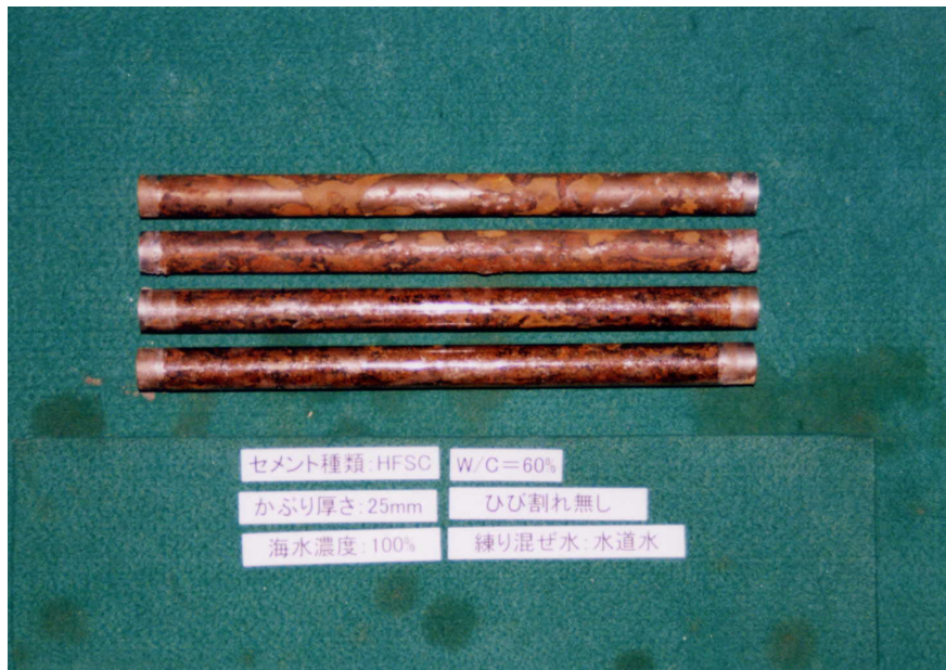
添付写真 1.49 脱錆前 (HFSC W/C=60%)
