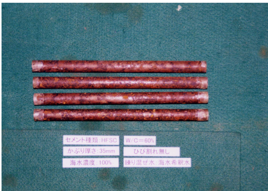
添付写真 1.33 脱錆前 (HFSC W/C=60%)
