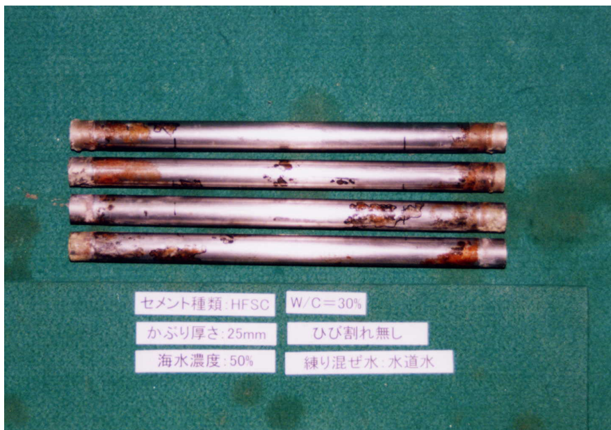
添付写真 1.3 脱錆前 (HFSC W/C=30%)
