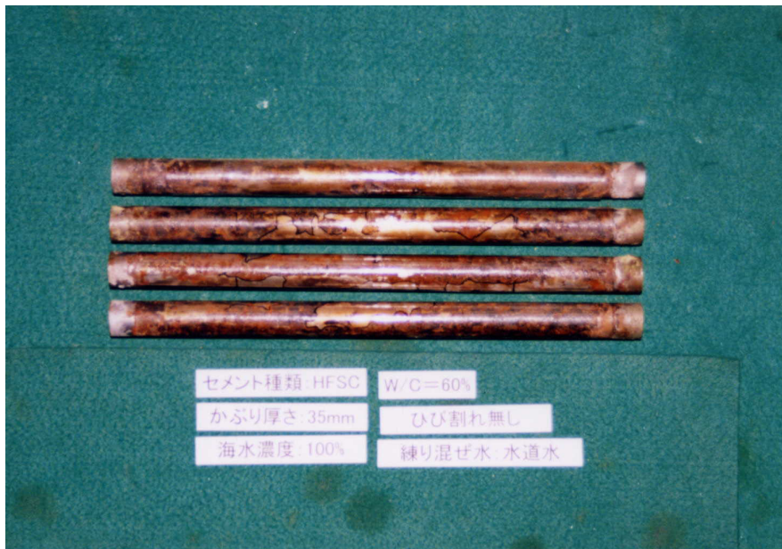
添付写真 1.65 脱錆前 (HFSC W/C=60%)
