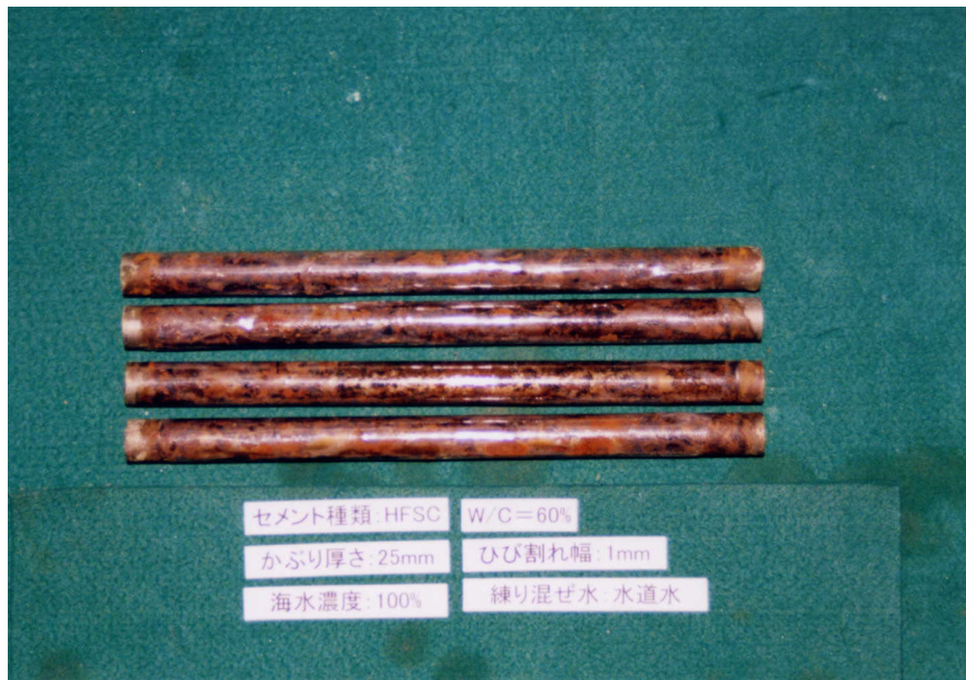
添付写真 1.25 脱錆前 (HFSC W/C=60%)
