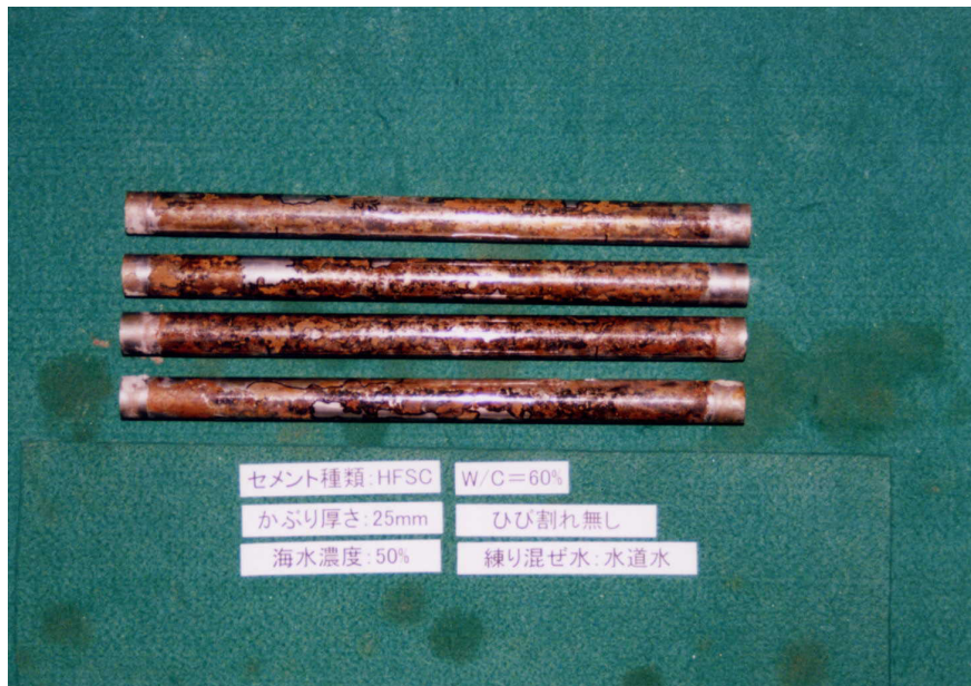
添付写真 1.41 脱錆前 (HFSC W/C=60%)
