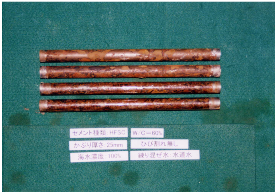
添付写真 1.13 脱錆前 (HFSC W/C=60%)
