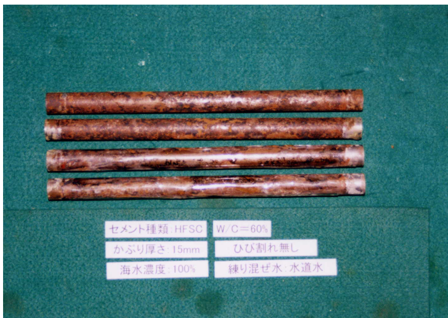
添付写真 1.45 脱錆前 (HFSC W/C=60%)
