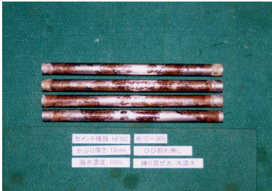
添付写真 1.44 脱錆前 (HFSC W/C=30%)
