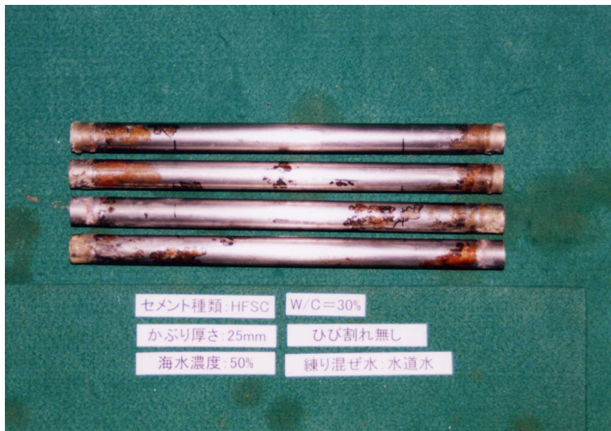
添付写真 1.39 脱錆前 (HFSC W/C=30%)
