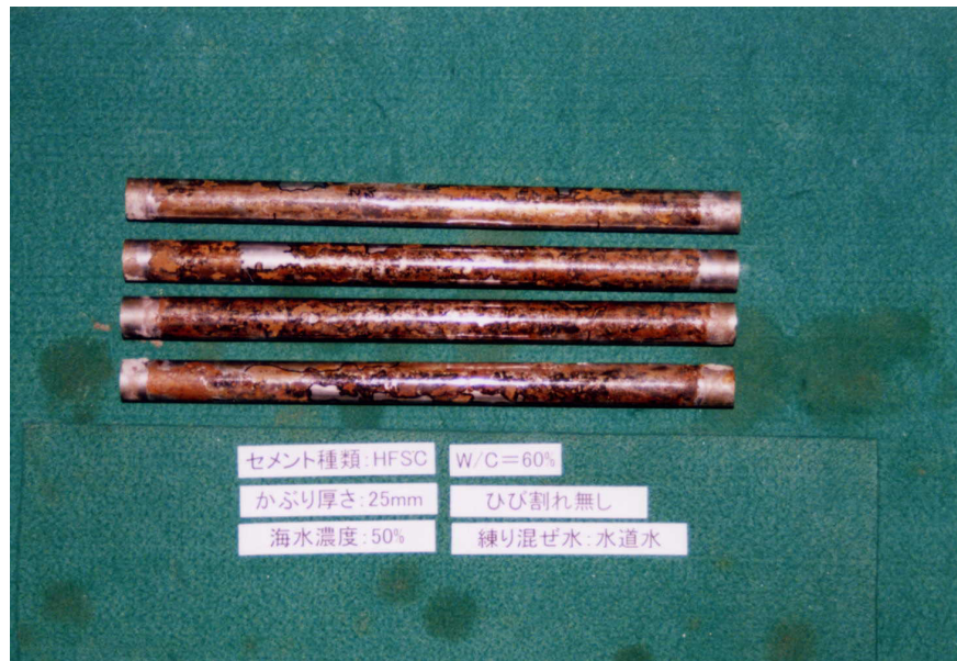
添付写真 1.5 脱錆前 (HFSC W/C=60%)
