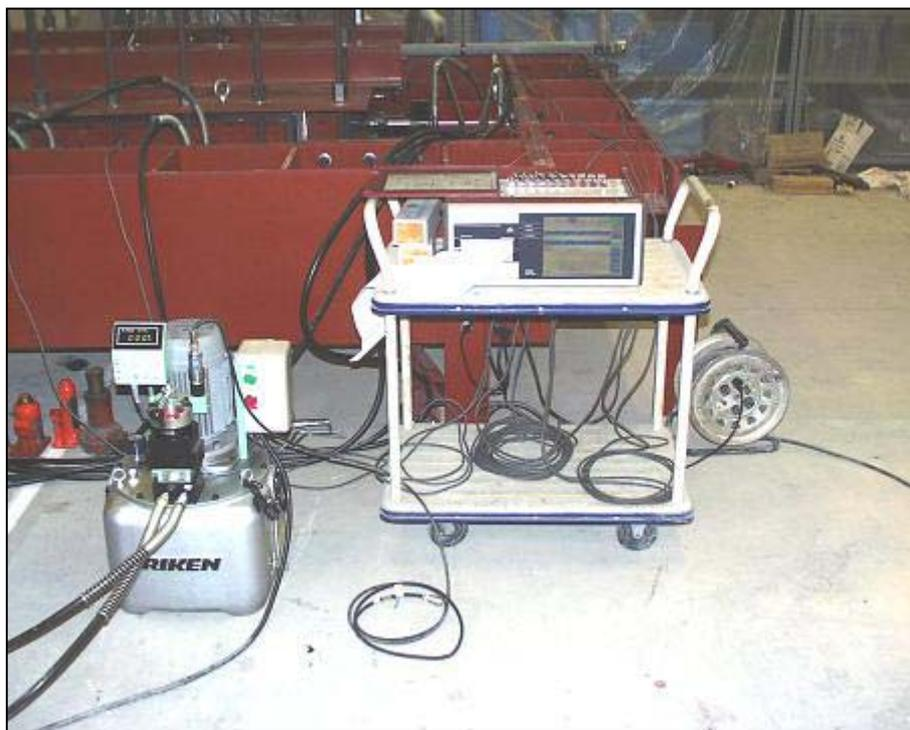
模型実験载荷装置 油圧ポンプおよび記録装置
