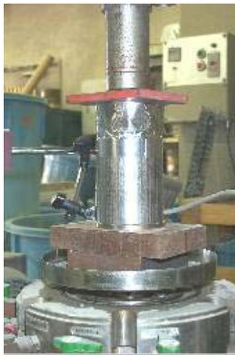
写真－2. 1 一軸圧縮試験試験状況
