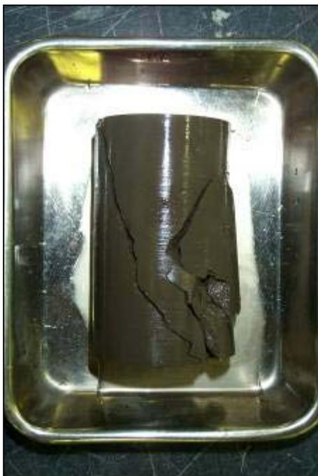
歪み速度繰返し一軸圧縮試験後（飽和：No.17）
