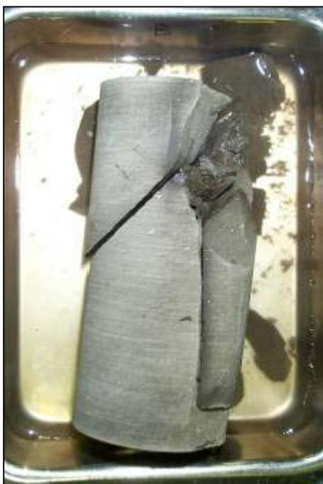
歪み速度繰返し一軸圧縮試験後（80℃：No.11）
