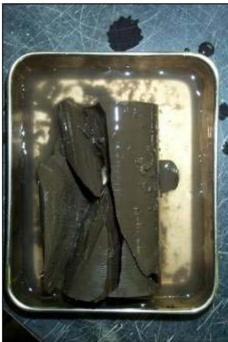
歪み速度繰返し一軸圧縮試験後（飽和：No.6）
