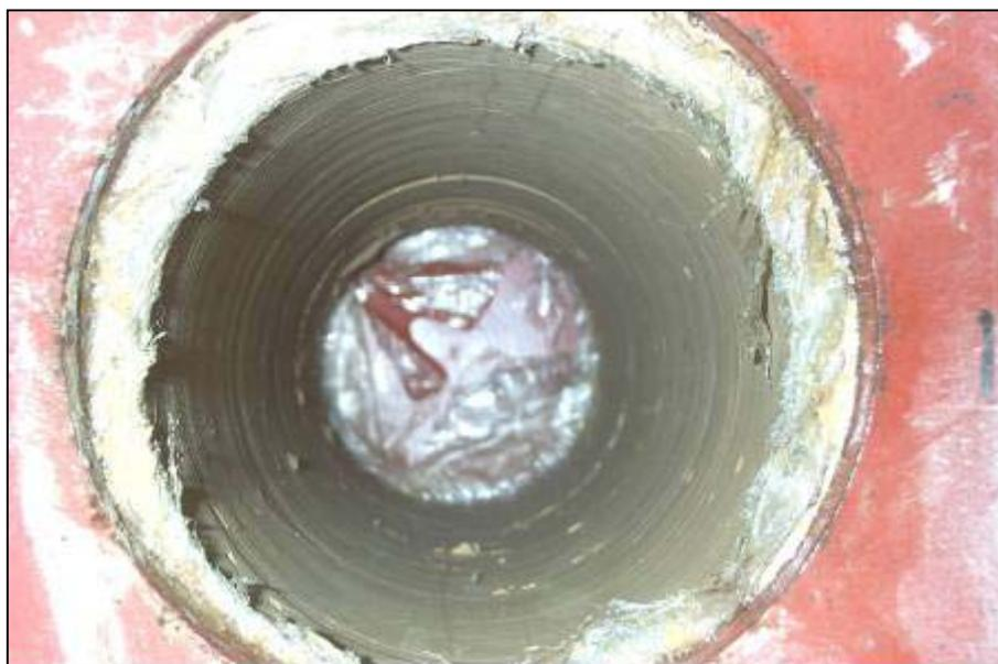
模型実験載荷装置 トンネル壁面状況
