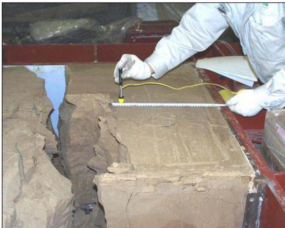
模型実験載荷装置 エコーチップ試験状況①
