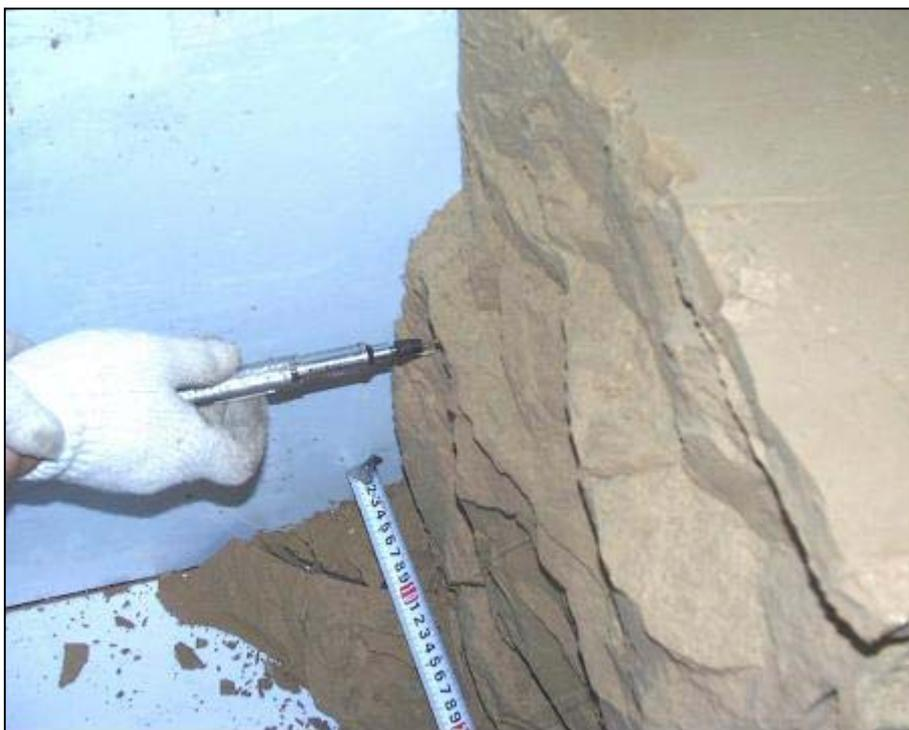
模型実験載荷装置 針貫入試験状況①
