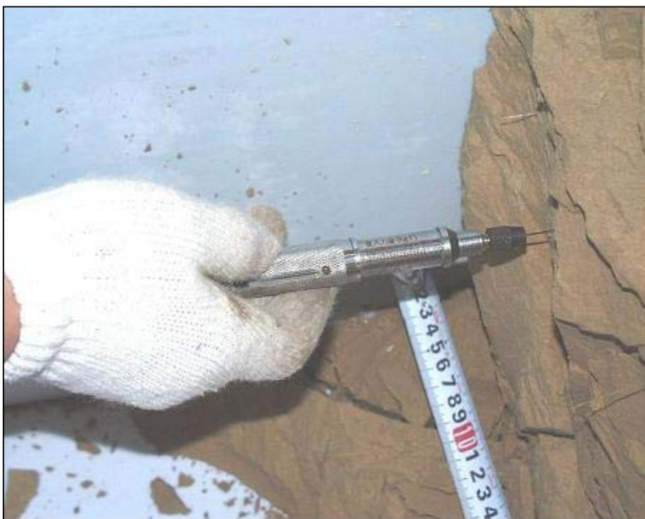
模型実験載荷装置 針貫入試験状況②
