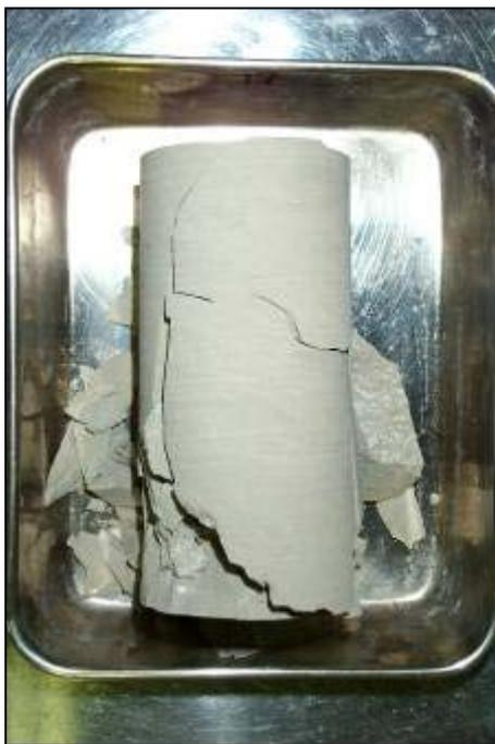
歪み速度繰返し一軸圧縮試験後（乾燥：No.16）
