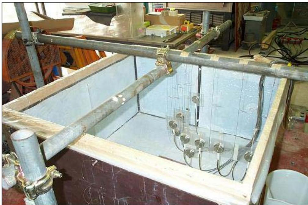
模型実験載荷装置 土圧計設置状況
