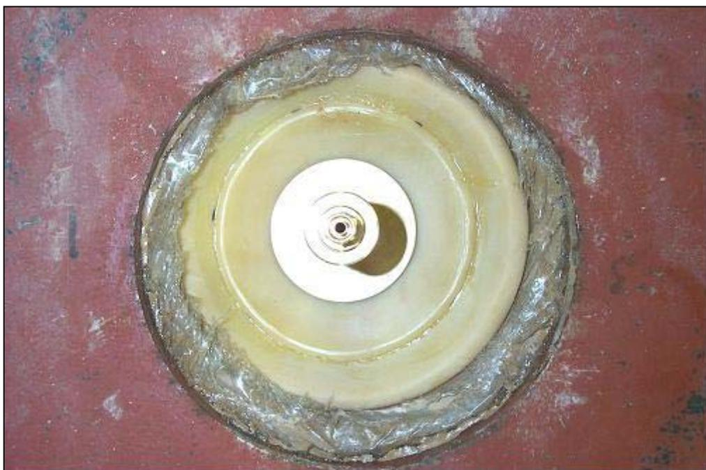
模型実験載荷装置 内圧装置設置状況
