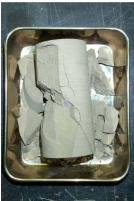
歪み速度繰返し一軸圧縮試験後（乾燥：No.12）
