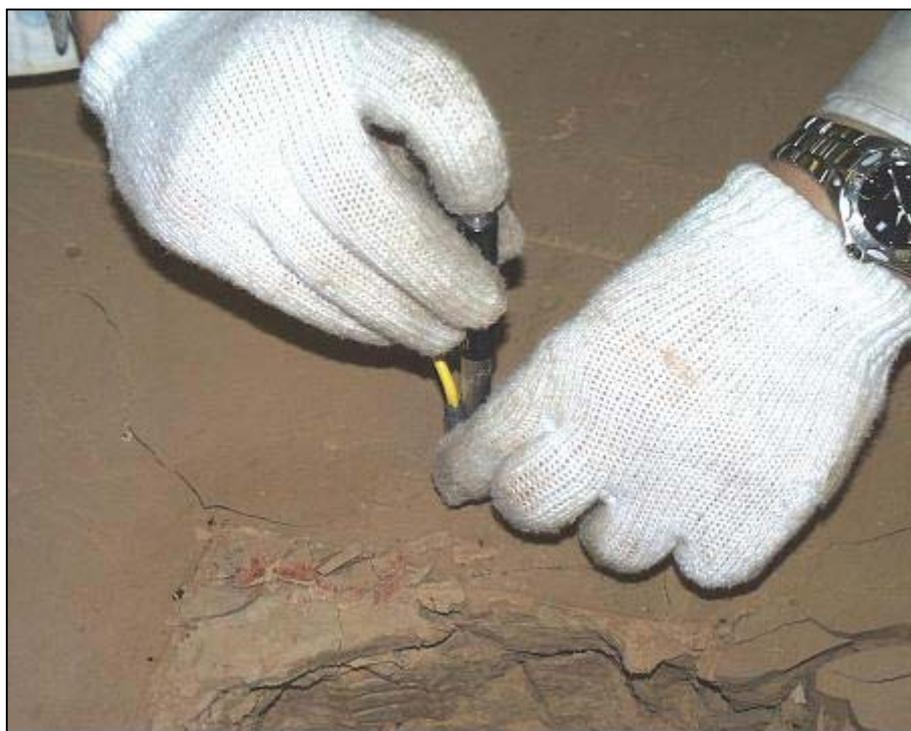
模型実験載荷装置 エコーチップ試験状況②
