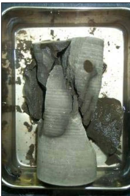
歪み速度繰返し一軸圧縮試験後（80℃：No.9）
