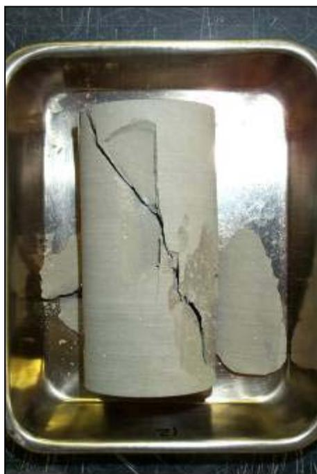
歪み速度繰返し一軸圧縮試験後（乾燥：No.14）
