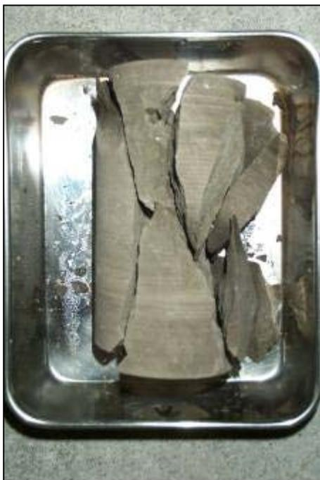
歪み速度繰返し一軸圧縮試験後（80℃：No.10）
