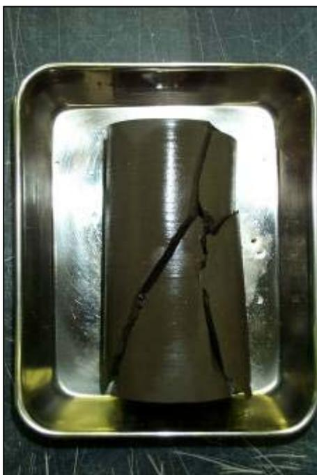
歪み速度繰返し一軸圧縮試験後（飽和：No.7）
