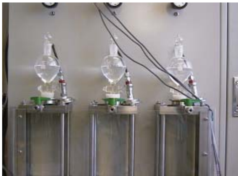
図 4.10 水頭圧試験状況
