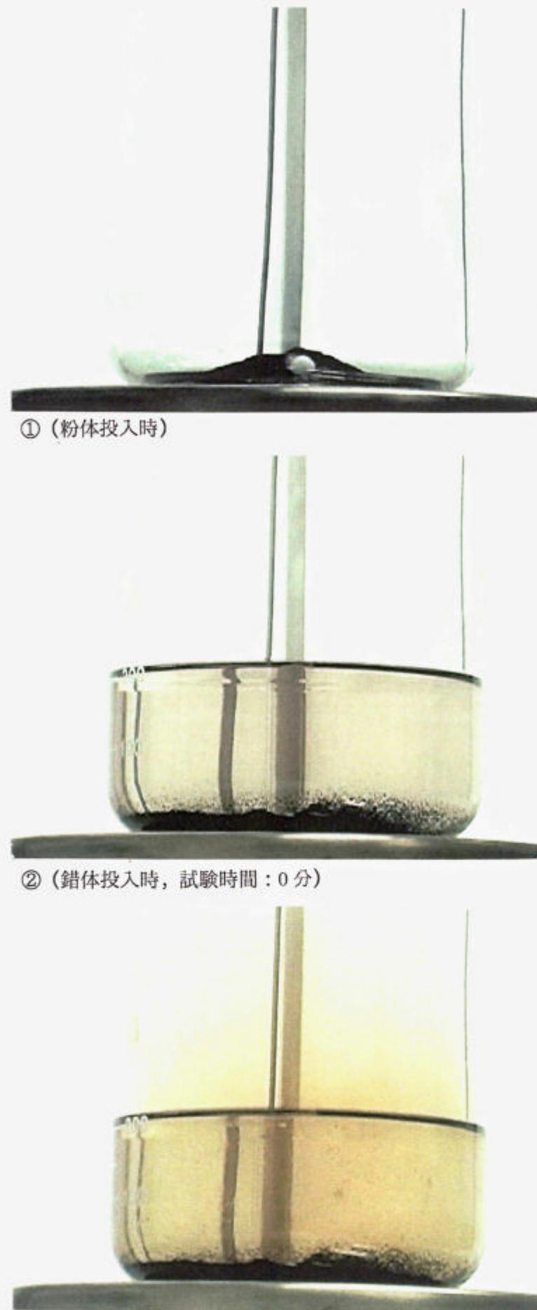
写真 5.5 粒径  $90\text{ }\mu\text{m}$  の  $\text{UO}_2$  粉体の  $40^\circ\text{C}$ での溶解試験(J3)における溶解状況 (1)
