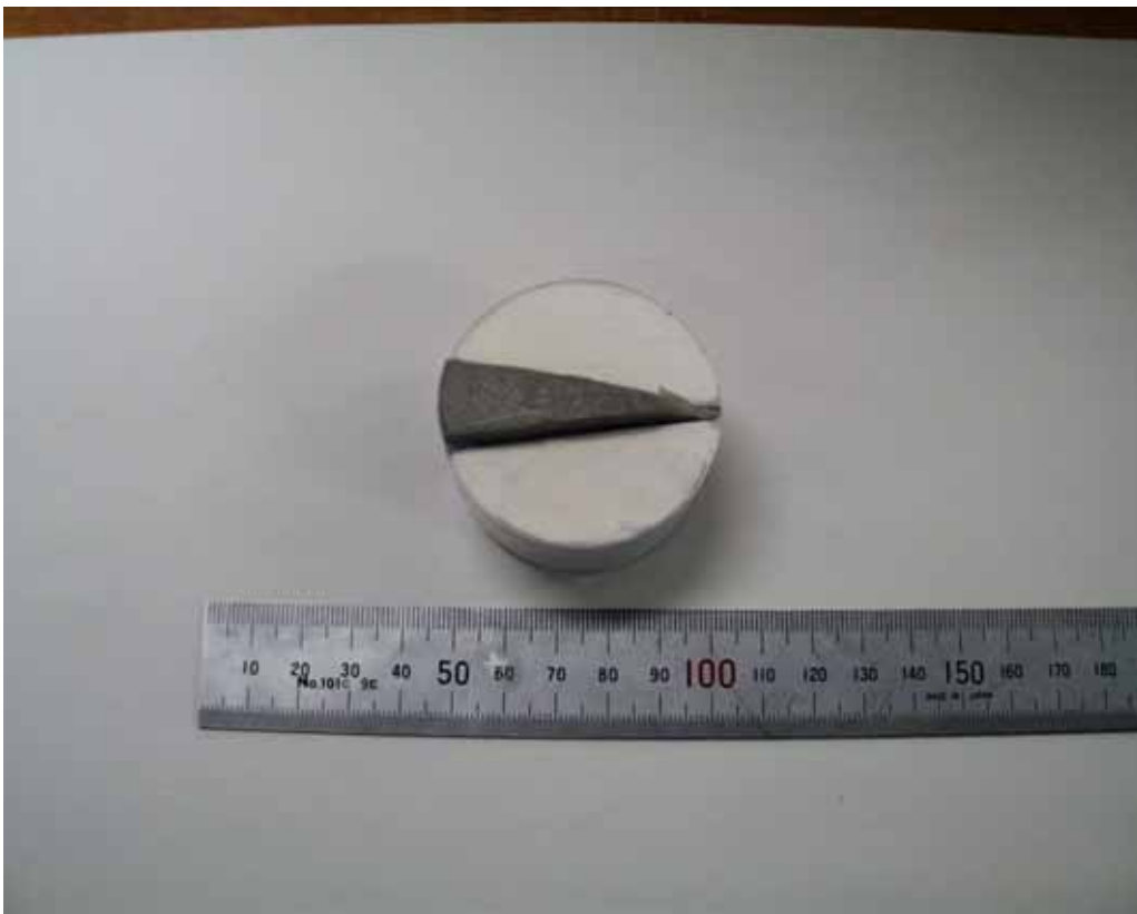
図 3-53 隙間充填状況（その1）
