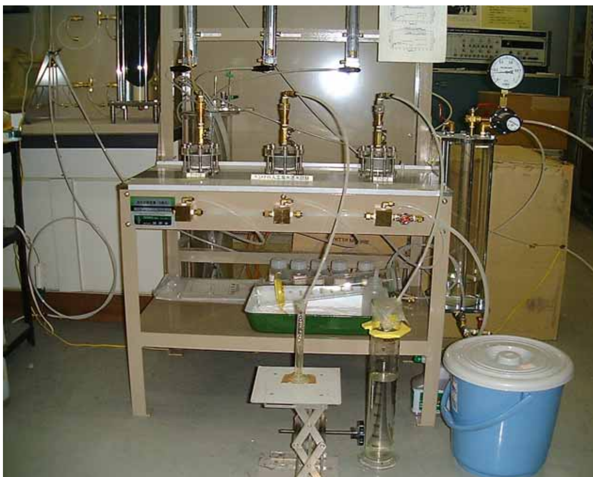
図 3-7 透水試験状況
