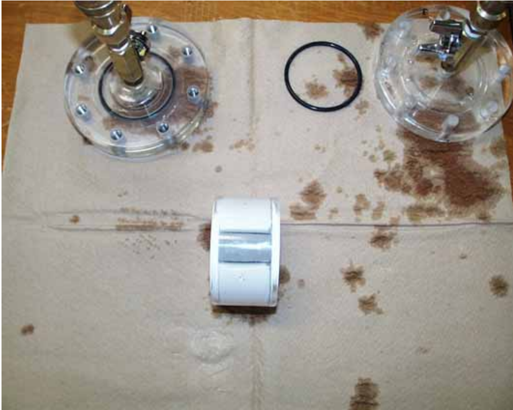
図 3-52 試験セル解体状況（楔形状隙間透水試験）
