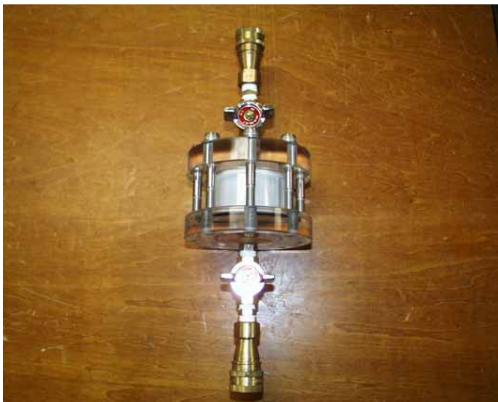
図 3-51 試験終了時の試験セル（楔形状隙間透水試験）
