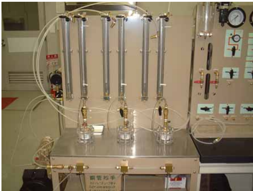
図 3-47 楔形状隙間に対する透水試験の様子（その 2）
