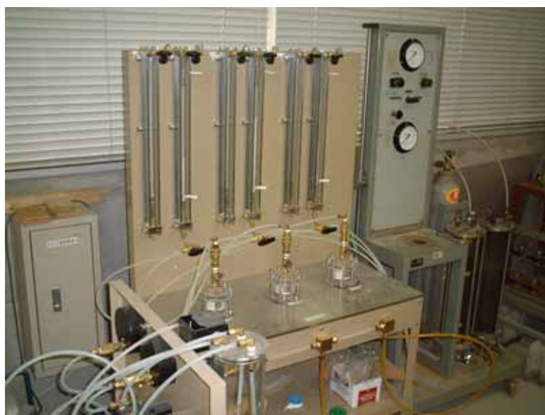
図 3-41 楔形状隙間に対する透水試験の様子
