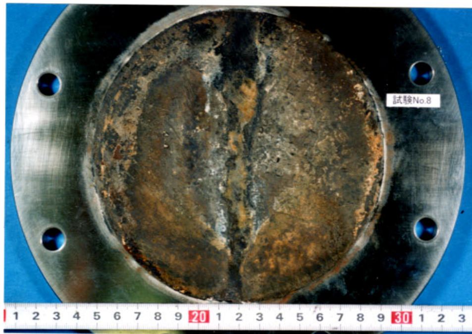
除錆前（付着した緩衝材除去後）
