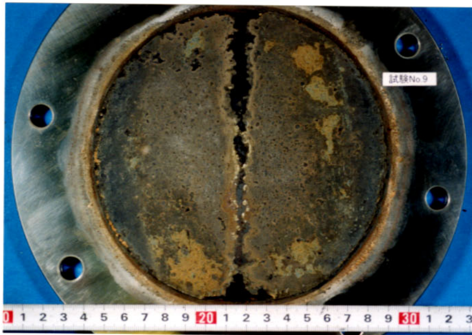
除錆前（付着した緩衝材除去後）
