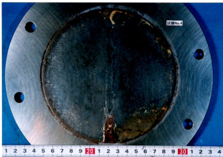
除錆前（付着した緩衝材除去後）
