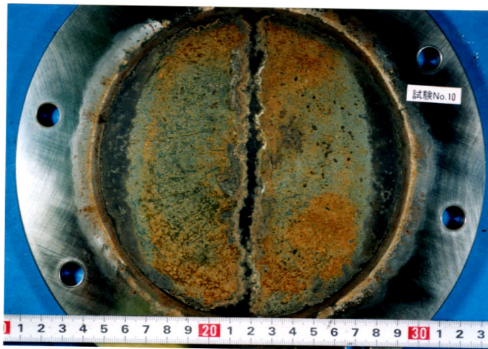
除錆前（付着した緩衝材除去後）
