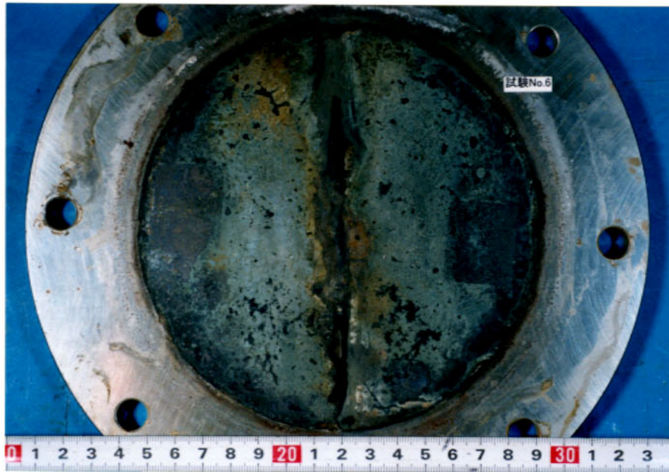
除錆前（付着した緩衝材除去後）
