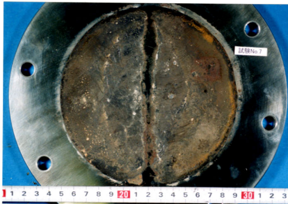
除錆前（付着した緩衝材除去後）
