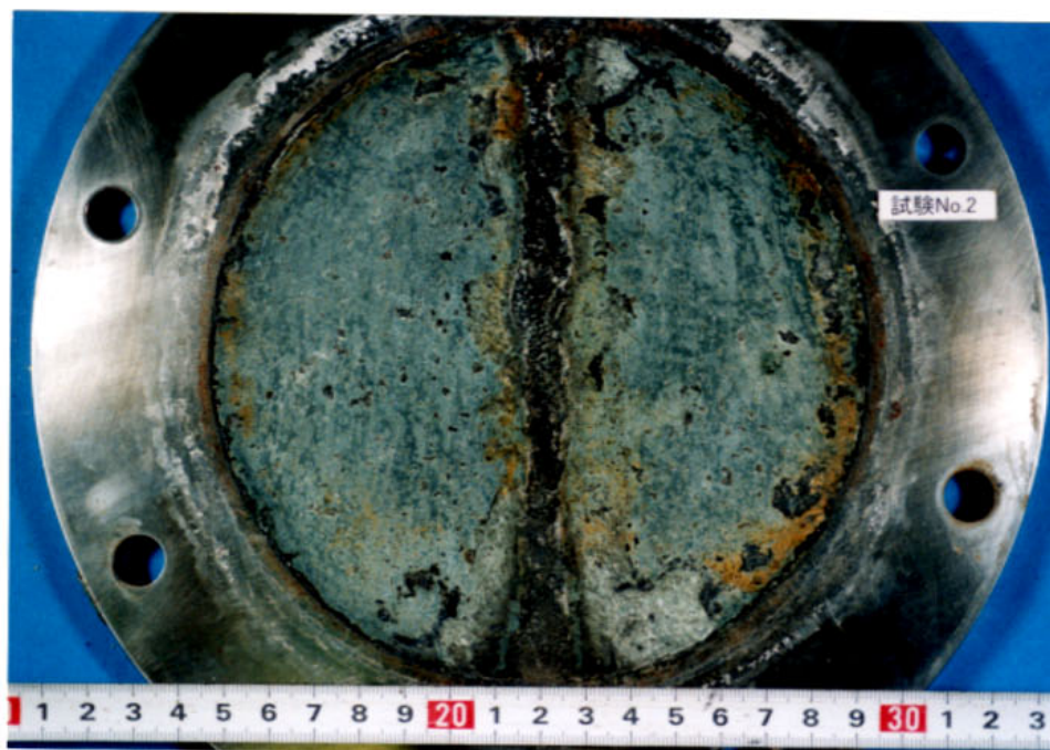
除錆前（付着した緩衝材除去後）
