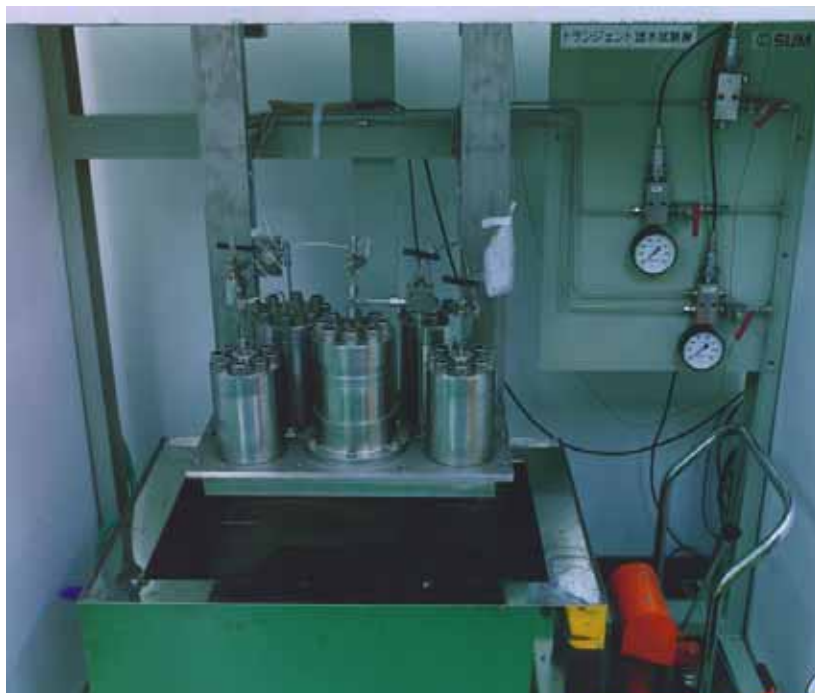
写真 6.1-1 トランジェントパルス透水試験装置概観
