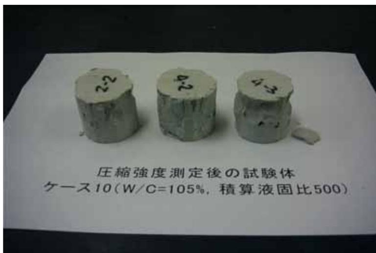
図 3-21 ケース 10 ( W/C=105% , 積算液固比 500 ) の圧縮強度測定後供試体
