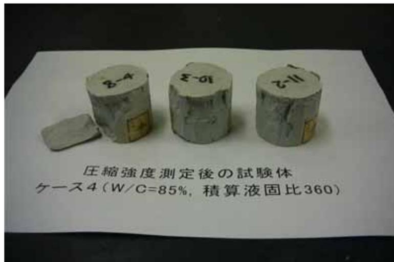
図 3-18 ケース 4 (W/C=85%, 積算液固比 360) の圧縮強度測定後供試体
