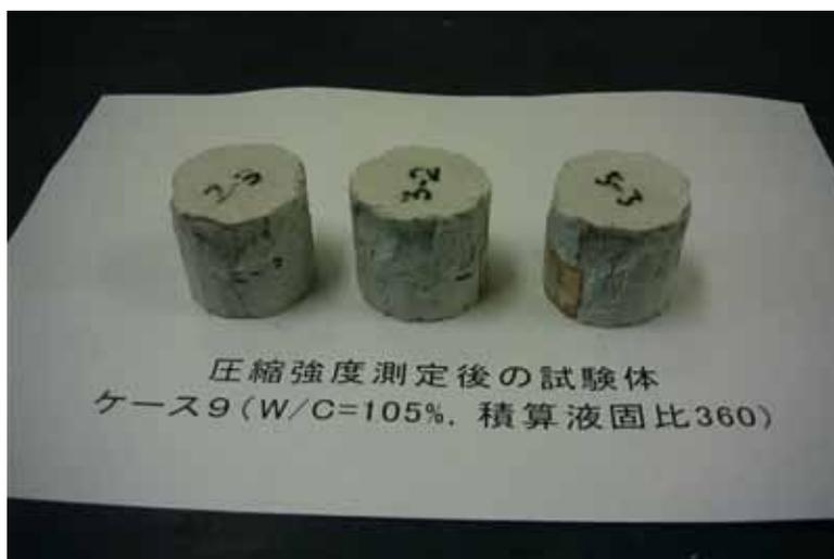
図 3-20 ケース 9 ( W/C=105% , 積算液固比 360 ) の圧縮強度測定後供試体
