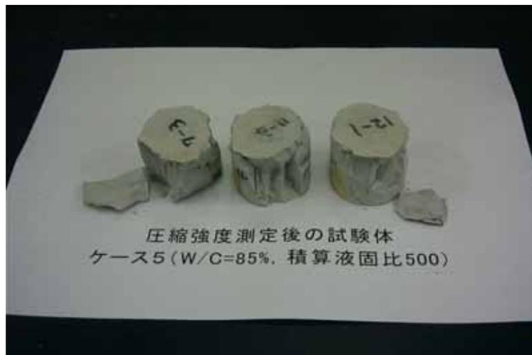
図 3-19 ケース 5 (W/C=85%, 積算液固比 500) の圧縮強度測定後供試体
