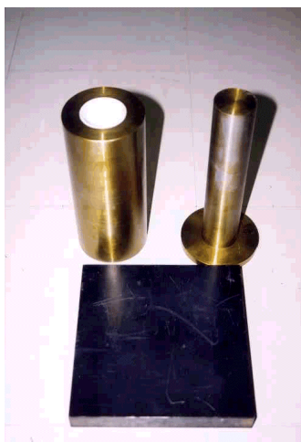
写真-1.10.1 三軸 \overline{CU} 試験/等方圧密除荷試験 (締固め治具)
