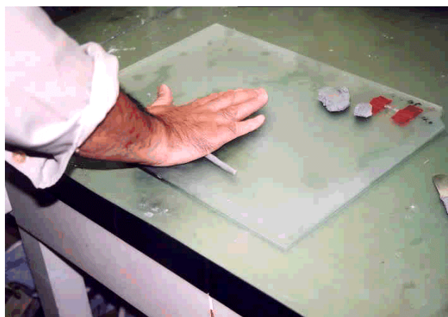
写真-1.8.3 液塑性限界試験（塑性限界試験状況 1）
