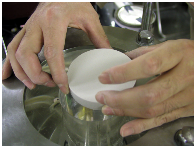
写真-2.9.2 積層ベントナイト検証試験（供試体設置）
