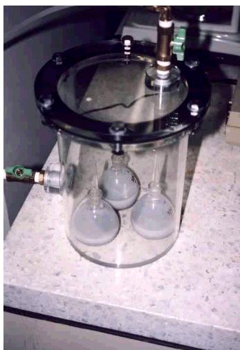
写真-1.6.2 土粒子の密度試験（脱気）
