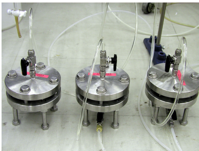
写真-1.13.4 透水試験（試験状況）
