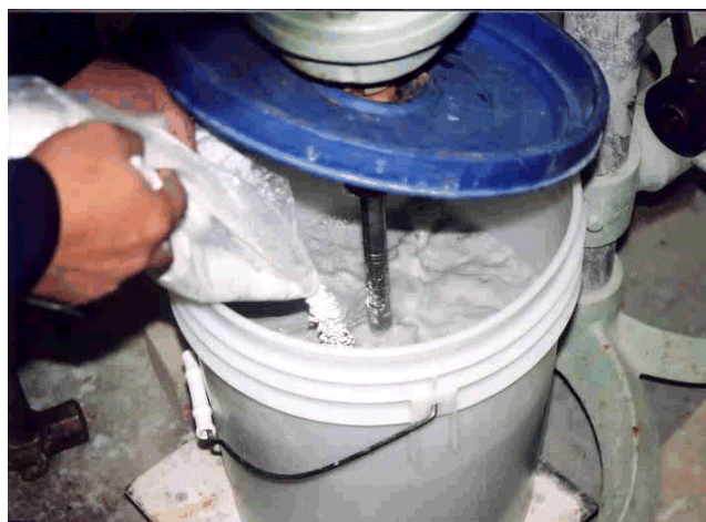
写真-1.3.3 Ca 型化ベントナイト作製（攪拌混合）
