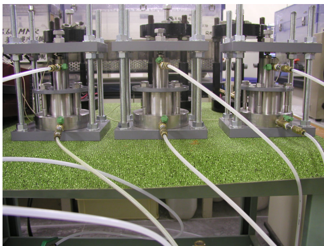
写真-1.14.2 膨潤圧試験（試験状況）
