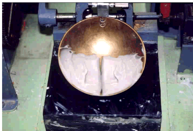
写真-1.8.2 液塑性限界試験（液性限界試験状況）
