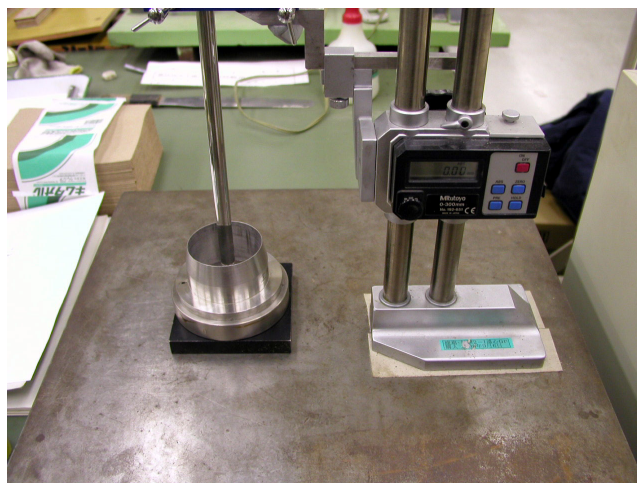
写真-1.11.4 高圧圧密試験（供試体寸法計測）
