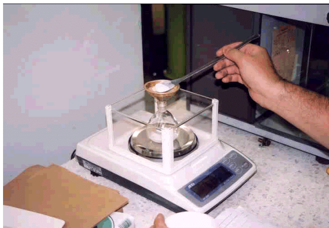
写真-1.6.1 土粒子の密度試験（試料計量）
