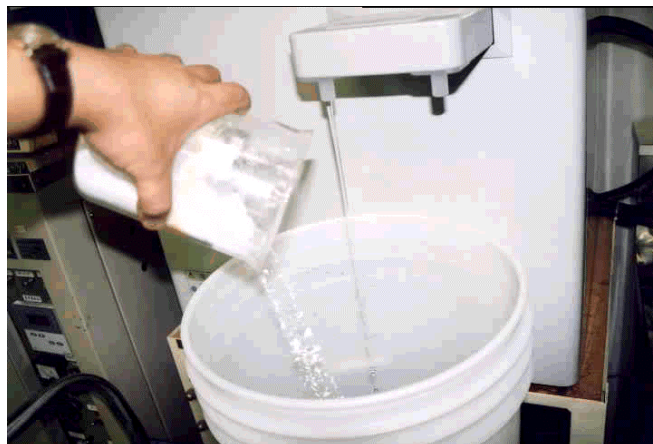
写真-1.3.1 Ca 型化ベントナイト作製（塩化カルシウム溶液の調製）
