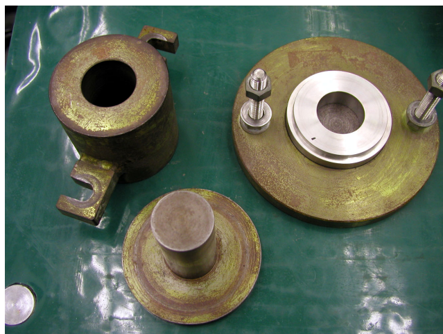
写真-1.13.1 透水試験（締固め容器）
