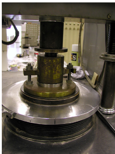
写真-1.13.2 透水試験（締固め状況）
