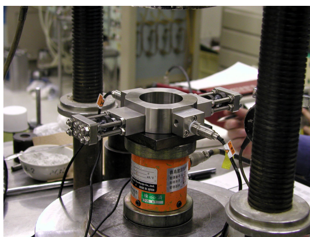
写真-1.12.3 K0 圧密除荷試験（締固め準備）
