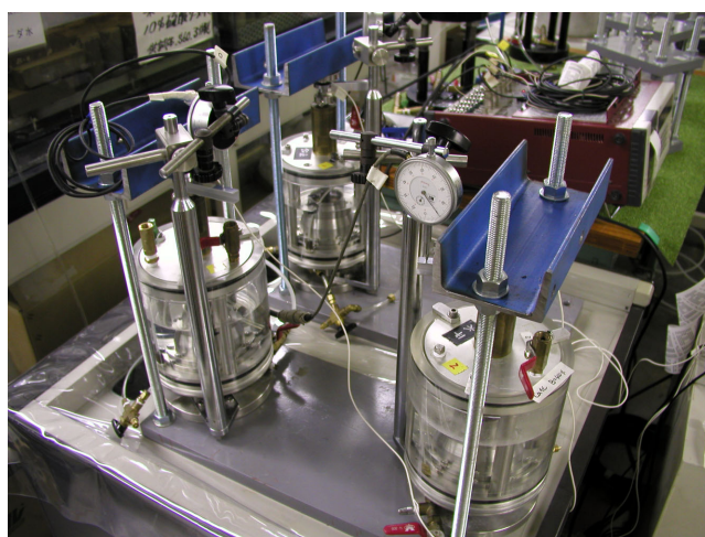
写真-1.15.3 膨潤量試験（飽和過程）
