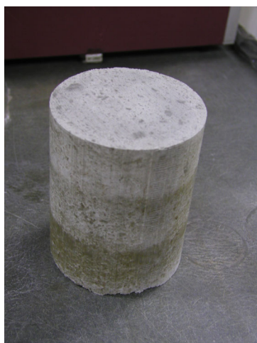
写真-1.9.4 締固め試験（締固め供試体）
