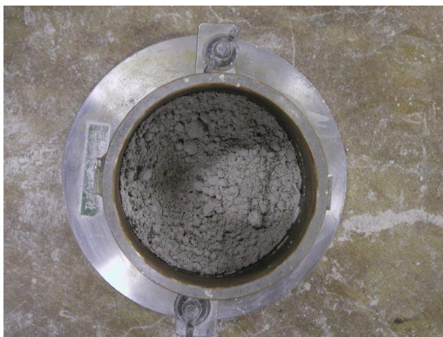
写真-1.9.1 締固め試験（試料投入）
