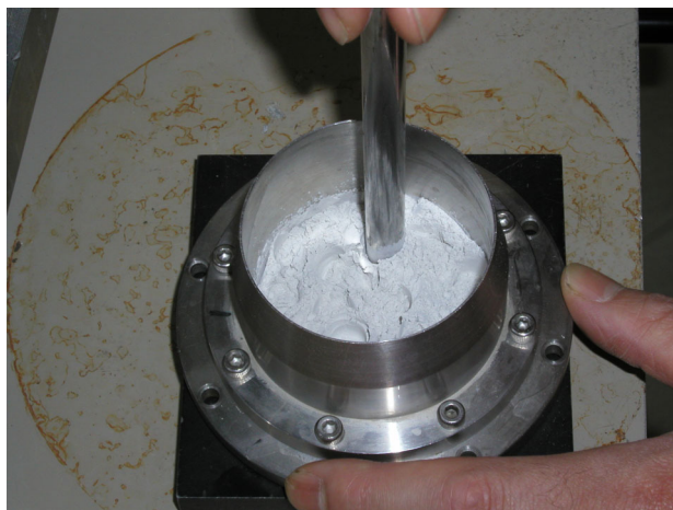
写真-1.15.1 膨潤量試験（締固め状況 1）
