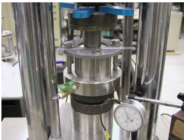
写真-1.14.1 膨潤圧試験（締固め状況）
