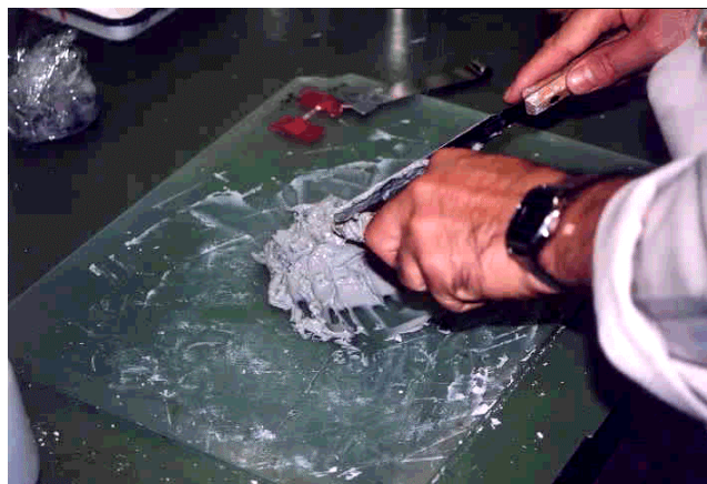
写真-1.8.1 液塑性限界試験（試料調製）
