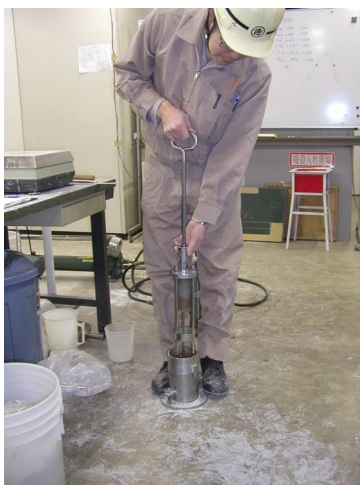
写真-1.9.2 締固め試験（締固め状況）
