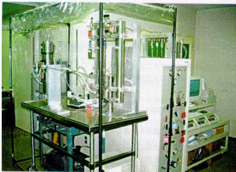
図 2-3 ガス透過試験装置全景
