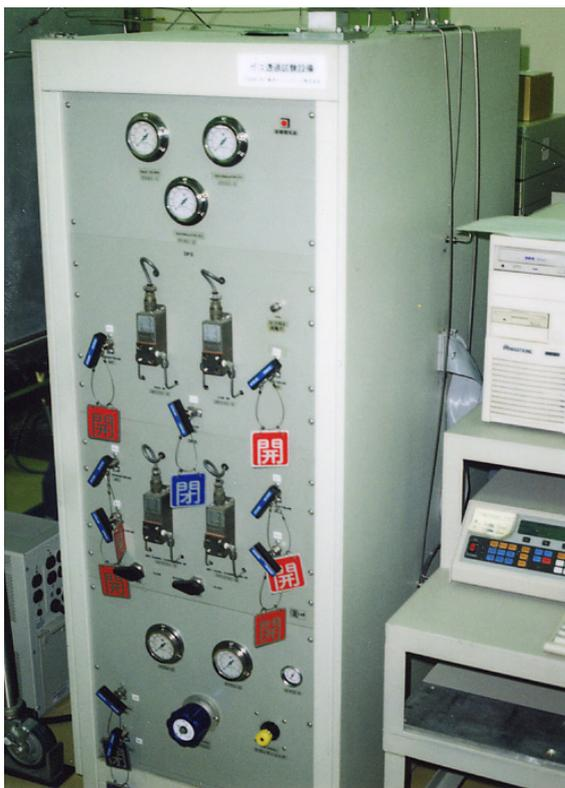
図 2-5 弁操作／圧力表示盤
