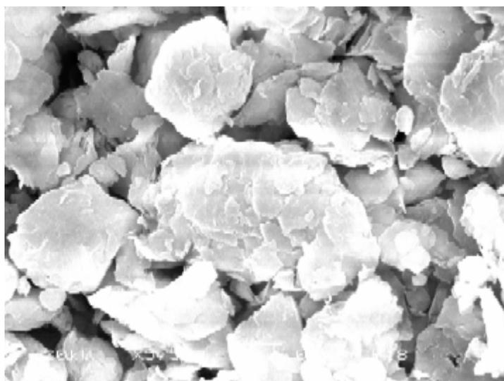
写真 2.32 置換処理：AWN、通水液 AWN 通水後
