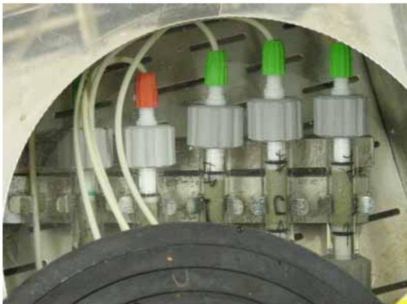
写真 4.3 カラム通水試験装置（セル 80 に制御した温水バスの状況）
