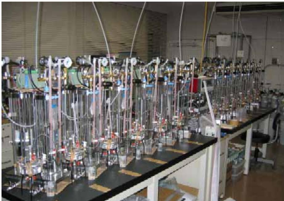
写真 2.2 透水試験実施状況
