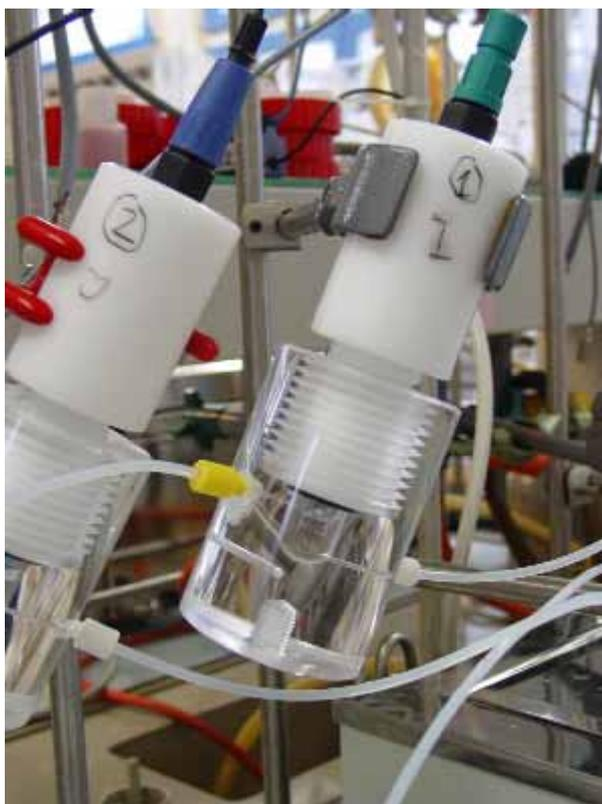
写真 4.4 カラム通水試験装置（pH 測定用のセルの状況）
