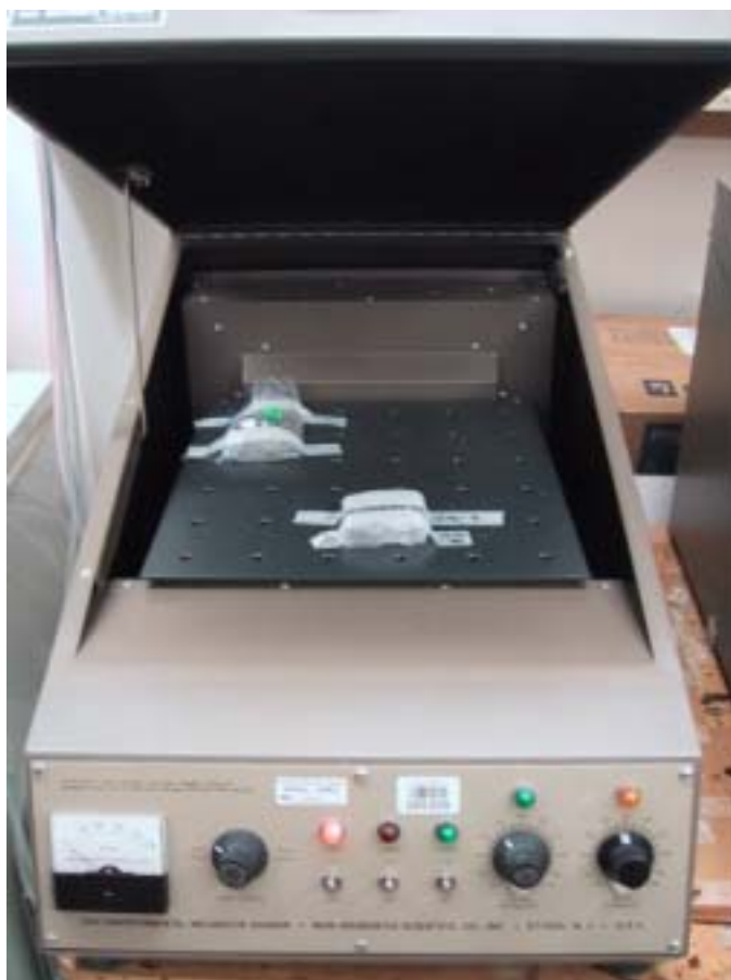
写真 3.1-8 弱い嫌気性微生物（または消化汚泥とベントナイトの混合溶液）とプルトニウムとの相互作用反応の状況（恒温器利用）
