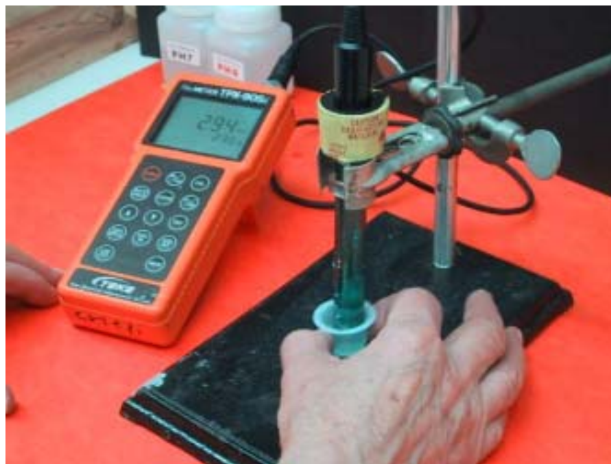
写真 3.1-2 微生物とプルトニウム混合物の pH と Eh の調整 (デモの様子)
