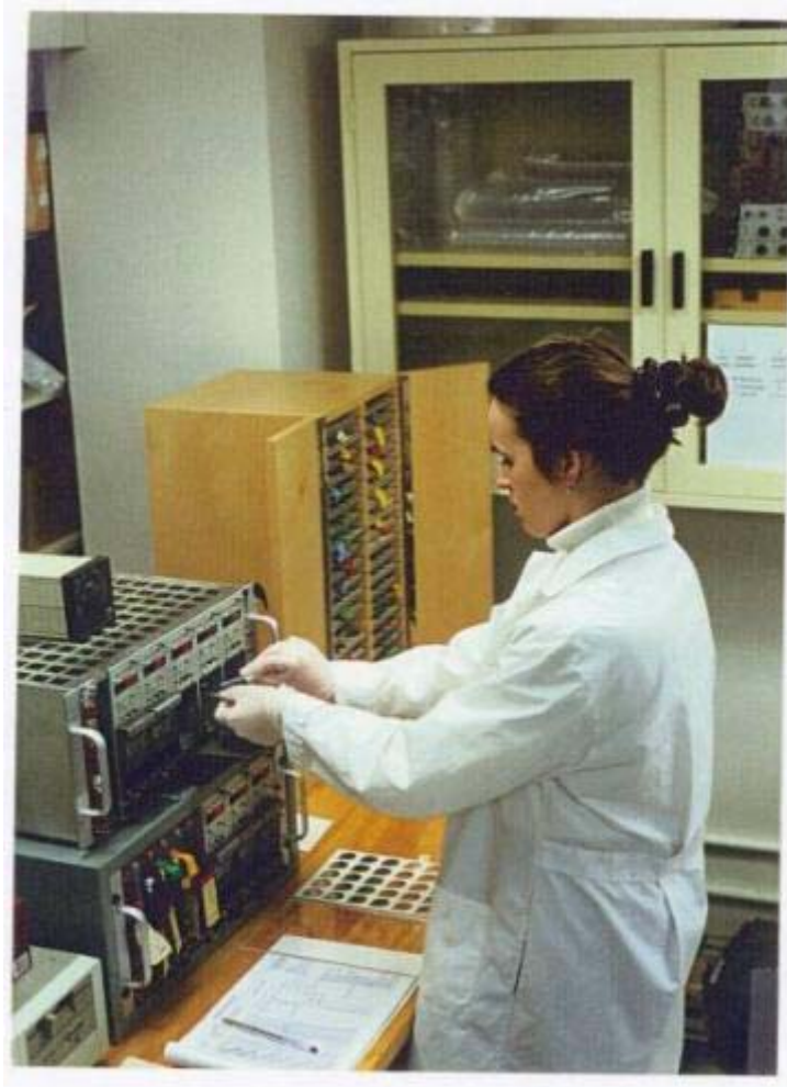
写真 3.1-13 アルファ線測定器によるプルトニウムの測定
