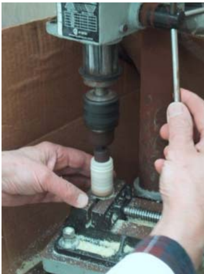
写真 3.1-10 プラスチック製密封 0.22 μm メンブレンフィルターの開封作業
