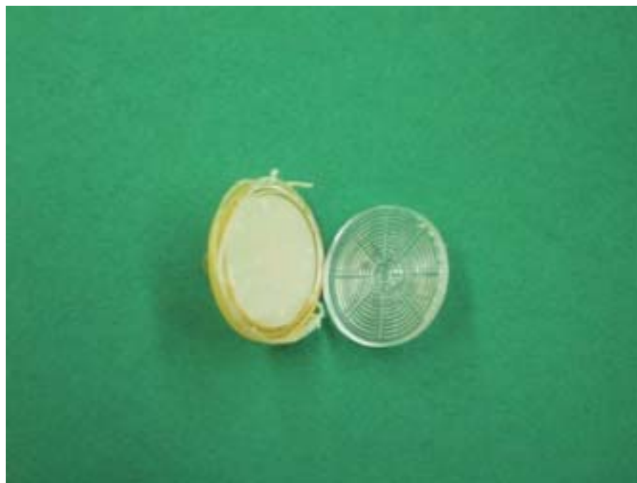
写真 3.1-11 開封されたプラスチック製密封 0.22 μm メンブレンフィルター
