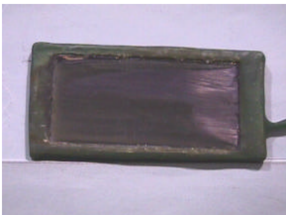
電氣的焼けと緑さび様 (Run7試験後試験片)
