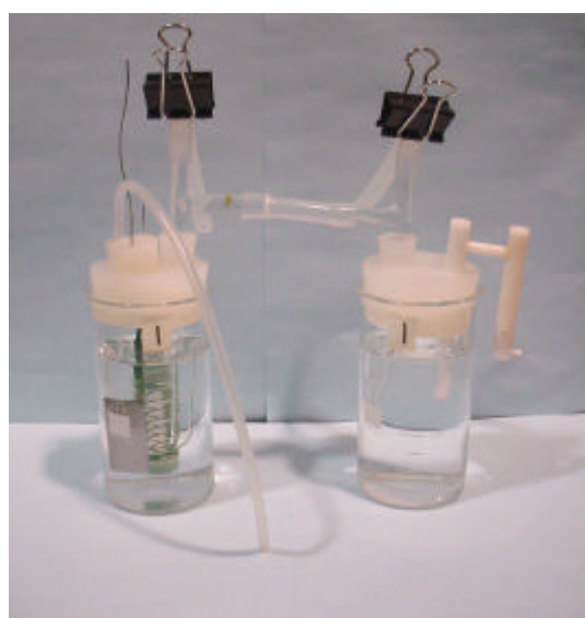
図3.2.1-2 電解セルの概要外観写真
