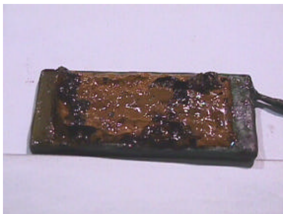
全面腐食 (Run8の試験後の試験片)
