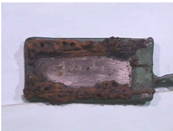
局部腐食 (Run10の試験後の試験片)
