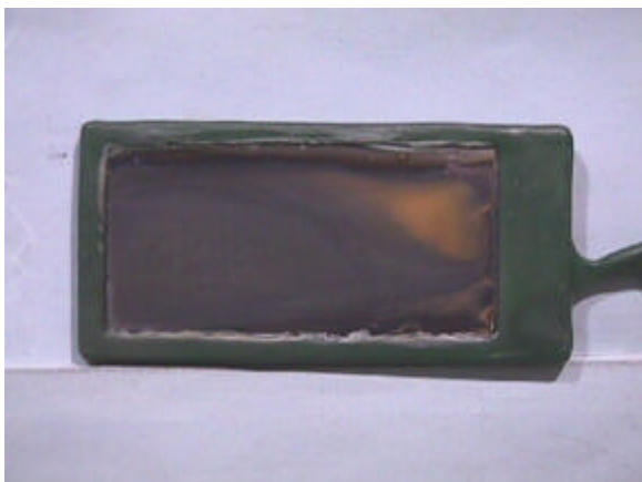
電氣的焼け現象 (Run1の試験後の試験片)
