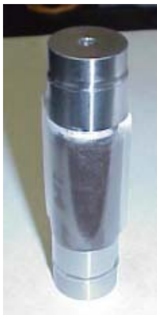
( c ) 熱収縮性チューブで覆った 一軸圧縮試験用の試験片
