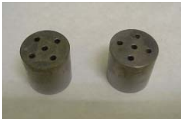
( a ) 鋼製プラテン
