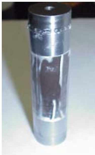
( a ) 熱収縮性チューブで覆った 三軸圧縮試験用の試験片
