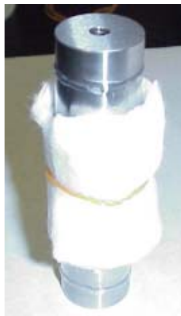
( b ) 水をしみこませた脱脂綿で 包んだ試験片
