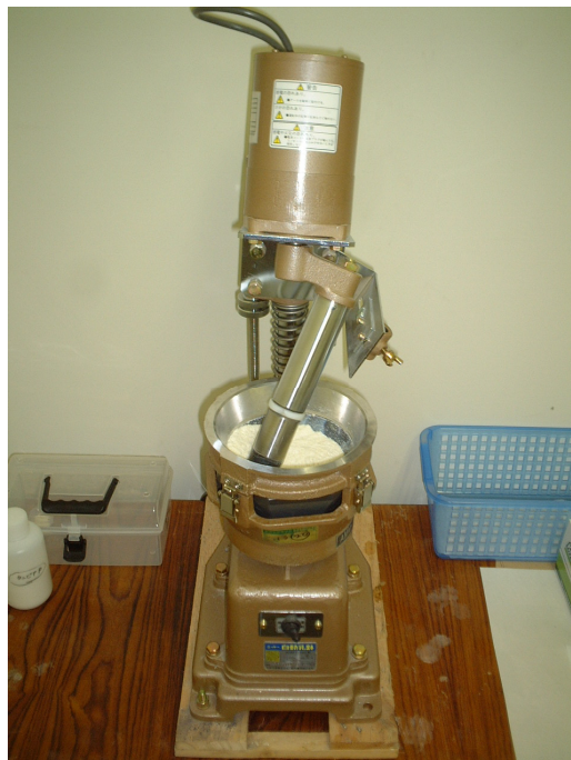
図 2.1.1-1 粉砕に用いた自動メノウ乳鉢 (AMD1000)
