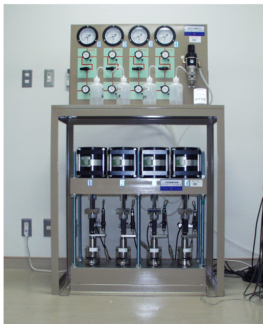
図 2.1.4-2 膨潤特性実験装置
