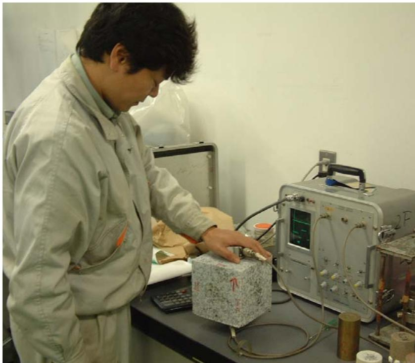
図 2-7 超音波速度試験実施状況
