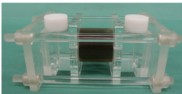
写真 4.4- 1 X 線 CT 撮影用拡散試験装置
